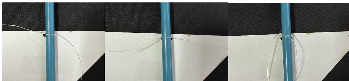
ภาพที่ 112 เทคนิคการผูกเอ็นกับแผ่นอะคริลิก
