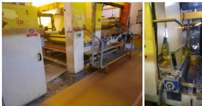
รูปที่ 2.12 ขั้นตอนการชุบกระดาษชั้นต่าง ๆ ด้วยน้ำยาเรซิน
