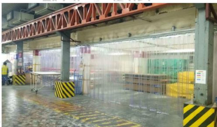
รูปที่ 3.18 ภายหลังการปรับปรุงแยกพื้นที่ระหว่างห้องซุบกระตาศและห้องประกอบกระตาศ
