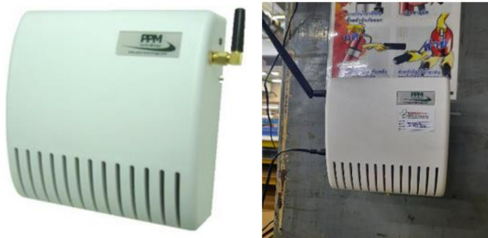
รูปที่ 3.6 เครื่อง Mini Wireless IAQ Profile Monitor
