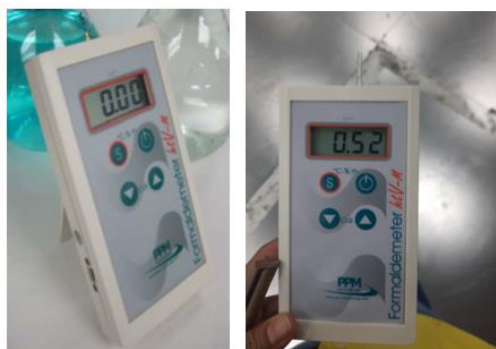
รูปที่ 3.5 เครื่อง Formaldemeter™ htV-M ที่มา : PPM Technology Ltd, 2022
