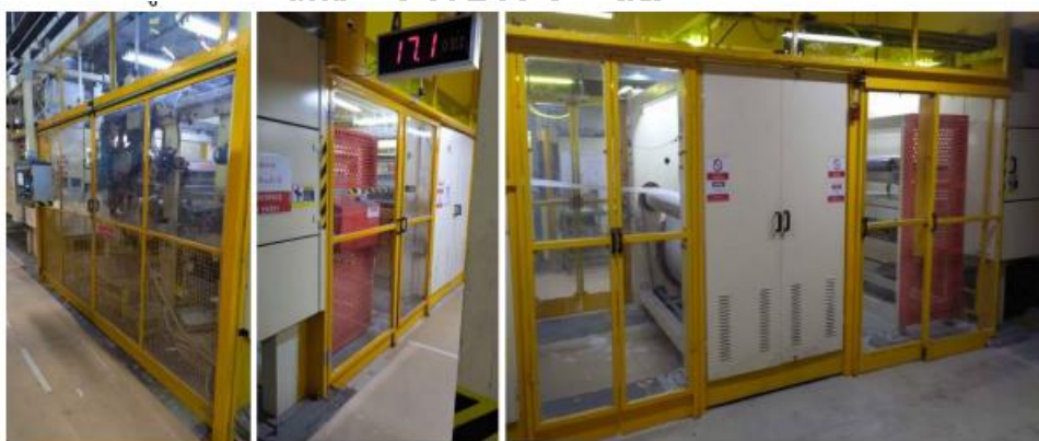
รูปที่ 3.10 การติดตั้งห้องกันพื้นที่บริเวณเครื่องชุบกระดาษ
