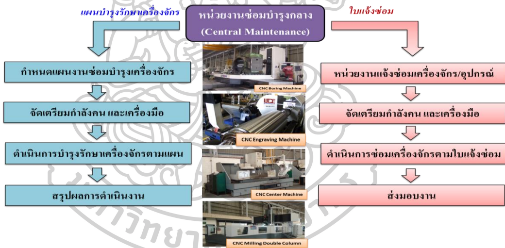
ภาพที่ 7 ขั้นตอนดำเนินงานหน่วยงานซ่อมบำรุงกลาง ที่มา: บริษัท เวสท์โคสต์ เอ็นจิเนียริง จำกัด (2565)
