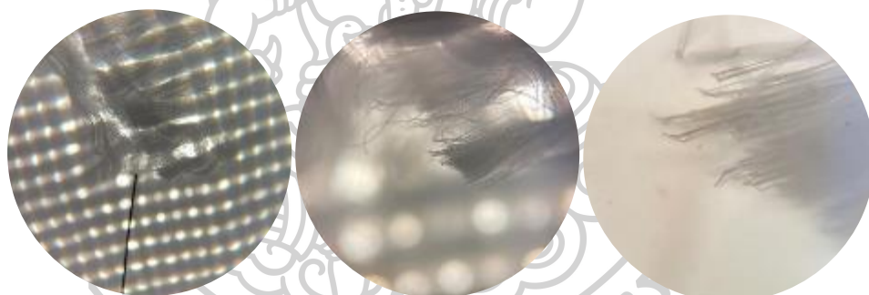
ภาพที่ 79 ขอบล่างของผ้าฝ้ายแบบแห้งที่แห้งด้วยมีดคีตเตอร์ขนาด 4x(ก), ขนาด 10x(ข), ขนาด 40x(ค)
