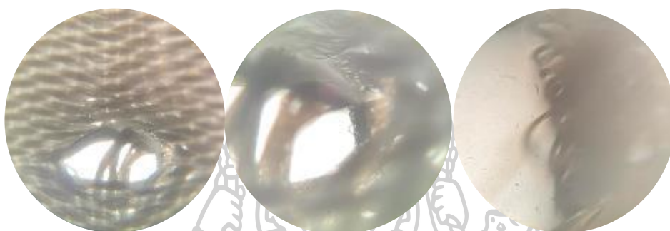
ภาพที่ 108 ขอบบนของผ้าโพลีเอสเตอร์แบบแห้งที่แทงด้วยไขควงปากแบนขนาด 4x(ก), ขนาด 10x(ข) และขนาด 40x(ค)
