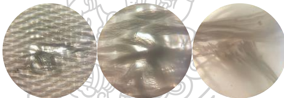
ภาพที่ 111 ขอบบนของผ้าโพลีเอสเตอร์แบบที่ผ่านการจุ่มน้ำที่แห้งด้วยมิตครวขนาด 4x(ก), ขนาด 10x(ข) และขนาด 40x(ค)
