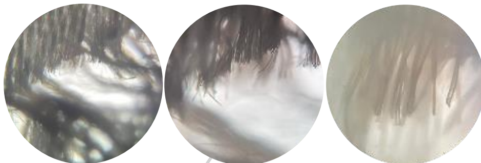
ภาพที่ 102 ขอบกลางของผ้าโพลีเอสเตอร์แบบแห้งที่แห้งด้วยมีดคัตเตอร์ขนาด 4x(ก), ขนาด 10x(ข) และขนาด 40x(ค)
