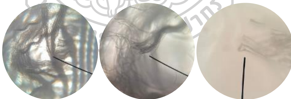
ภาพที่ 82 ขอบล่างของผ้าฝ้ายแบบแห้งที่แห้งด้วยกรรไกรปลายแหลมขนาด 4x(ก), ขนาด 10x(ข), ขนาด 40x(ค)
