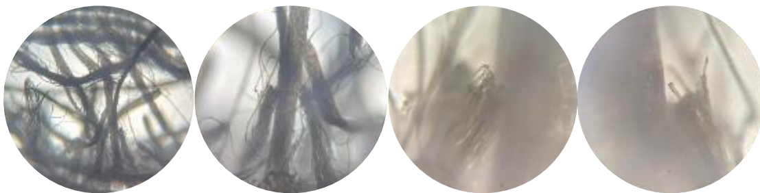
ภาพที่ 96 ขอบกลางของผ้าฝ้ายแบบที่ผ่านการจุ่มน้ำที่แห้งด้วยไซควงปากแบนขนาด 4x(ก), ขนาด 10x(ข) และขนาด 40x (ค และง)
