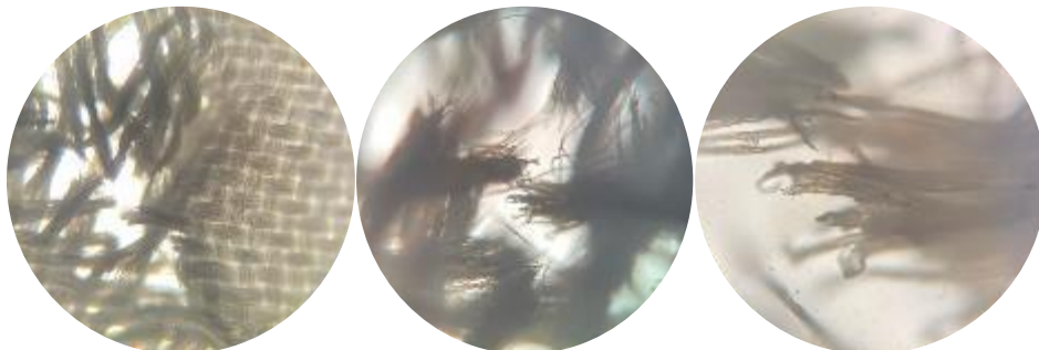
ภาพที่ 119 ขอบล่างของผ้าโพลีเอสเตอร์แบบที่ผ่านการจุ่มน้ำที่แทงด้วยกรรไกรปากแหลมขนาด 4x(ก), ขนาด 10x(ข) และขนาด 40x(ค)
