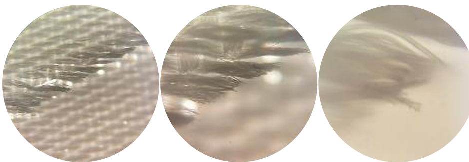
ภาพที่ 112 ขอบกลางของผ้าโพลีเอสเตอร์แบบที่ผ่านการจุ่มน้ำที่แห้งด้วยมิตครวขนาด 4x(ก), ขนาด 10x(ข) และขนาด 40x(ค)
