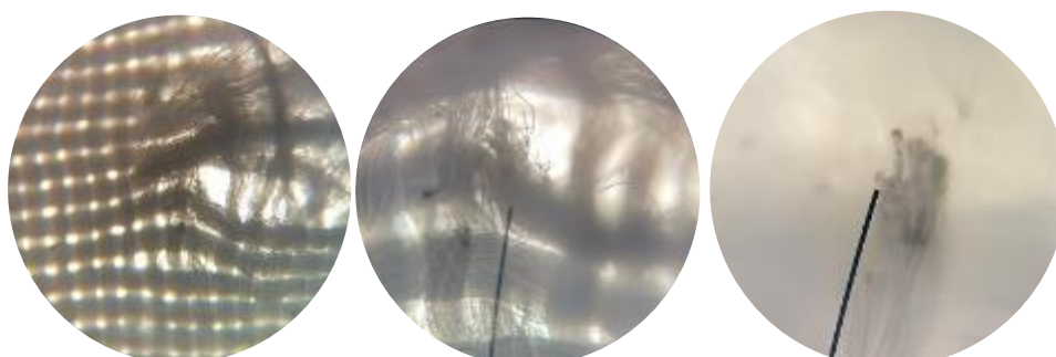
ภาพที่ 77 ขอบบนของผ้าฝ้ายแบบแห้งที่แห้งด้วยมิตคัตเตอร์ขนาด 4x(ก), ขนาด 10x(ข), ขนาด 40x(ค)
