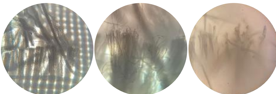
ภาพที่ 93 ขอบล่างของผ้าฝ้ายแบบที่ผ่านการจุ่มน้ำที่แห้งด้วยกรไถรปลายแหลมขนาด 4x(ก), ขนาด 10x(ข) และขนาด 40x(ค)
