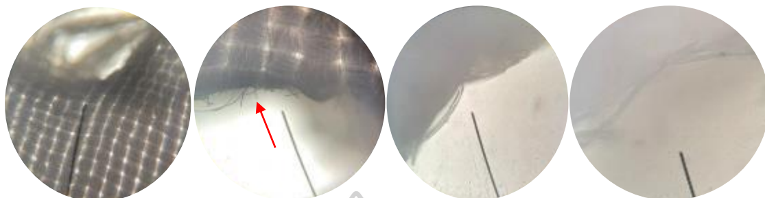
ภาพที่ 83 ขอบรอยแฉกของผ้าฝ้ายแบบแห้งที่แทงด้วยไขควงปากแฉกขนาด 4x(ก), ขนาด 10x(ข), ขนาด 40x(ง)
