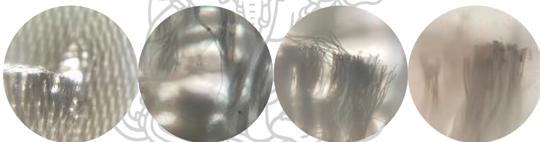
ภาพที่ 103 ขอบกลางของผ้าโพลีเอสเตอร์แบบแห้งที่แห้งด้วยมีดคัตเตอร์ขนาด 4x(ก), ขนาด 10x(ข-ค) และขนาด 40x(ง)
