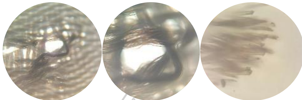
ภาพที่ 116 ขอบกลางของผ้าโพลีเอสเตอร์แบบที่ผ่านการจุ่มน้ำที่แทงด้วยมีดคัตเตอร์ขนาด 4x(ก), ขนาด 10x(ข) และขนาด 40x(ค)
