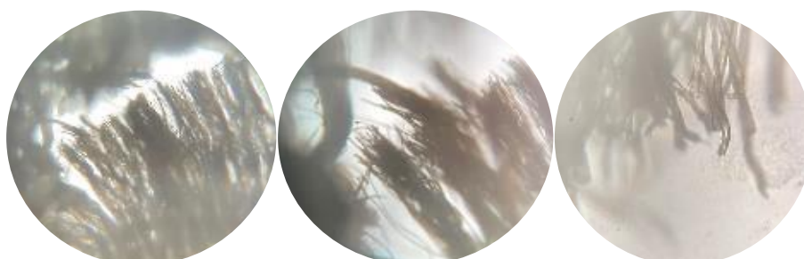
ภาพที่ 101 ขอบบนของผ้าโพลีเอสเตอร์แบบแห้งที่แห้งด้วยมิตคัตเตอร์ขนาด 4x(ก), ขนาด 10x(ข) และขนาด 40x(ค)
