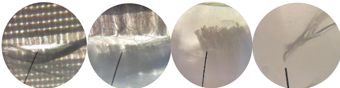
ภาพที่ 75 ขอบกลางของผ้าฝ้ายแบบแห้งที่แห้งด้วยมิตครีวขนาด 4x(ก), ขนาด 10x(ข), ขนาด 40x(ค)
