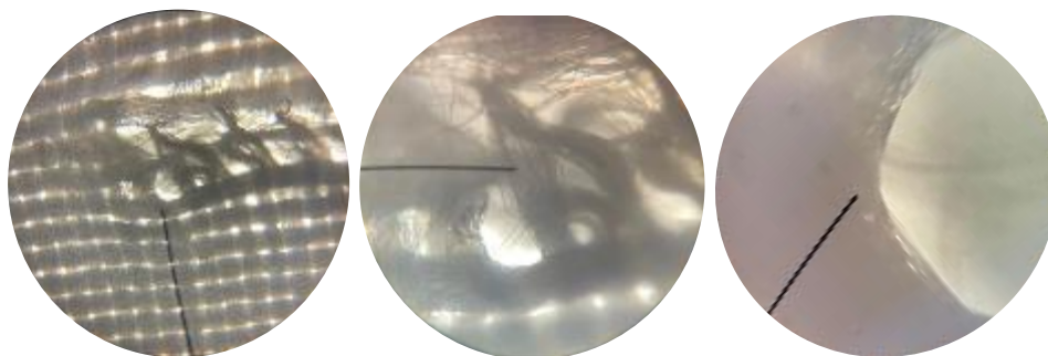
ภาพที่ 74 ขอบบนของผ้าฝ้ายแบบแห้งที่แทงด้วยมีดครัวขนาด 4x(ก), ขนาด 10x(ข), ขนาด 40x(ค)
