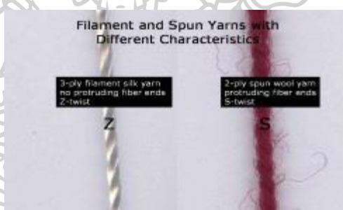
ภาพที่ 11 การควบเกลียวหลอดตามเข็มนาฬิกา (Z twist) และเกลียวหมุนทวนเข็มนาฬิกา (S twist)
