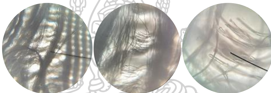
ภาพที่ 81 ขอบกลางของผ้าฝ้ายแบบแห้งที่แห้งด้วยกรรไกรปลายแหลมขนาด 4x(ก), ขนาด 10x(ข), ขนาด 40x(ค)
