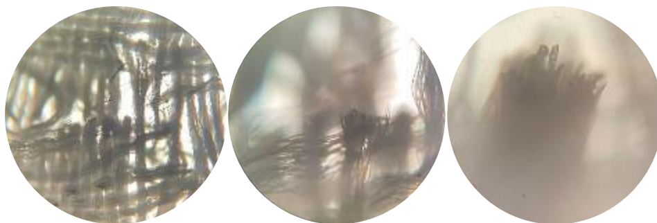
ภาพที่ 118 ขอบกลางของผ้าโพลีเอสเตอร์แบบที่ผ่านการจุ่มน้ำที่แทงด้วยกรไกรปากแหลมขนาด 4x(ก), ขนาด 10x(ข) และขนาด 40x(ค)
