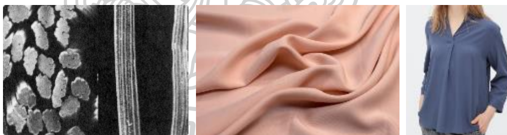
ภาพที่ 19 โครงสร้างเส้นใยเรยอน และตัวอย่างเสื้อผ้าที่ทำจากเรยอน
