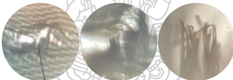
ภาพที่ 100 ขอบล่างของผ้าโพลีเอสเตอร์แบบแห้งที่แห้งด้วยมิตครวขนาด 4x(ก), ขนาด 10x(ข) และขนาด 40x(ค)
