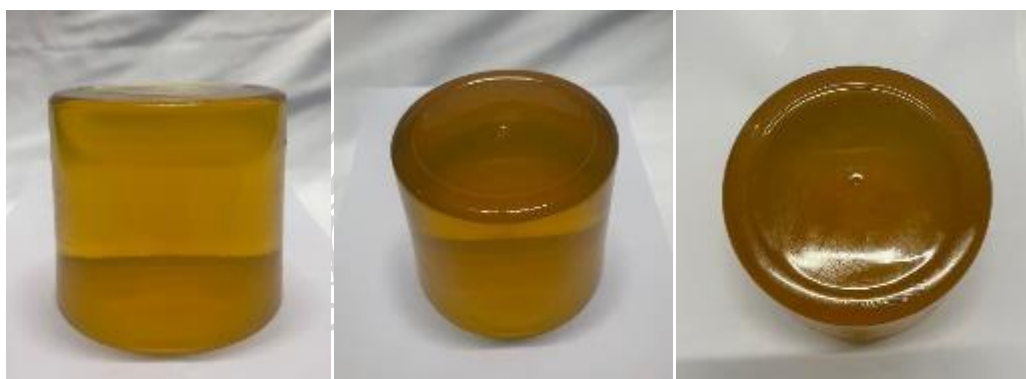
ภาพที่ 46 แบบจำลองเจลลาตินที่เซตตัวแล้ว (ด้านข้าง, ด้านหน้า และด้านบน)
