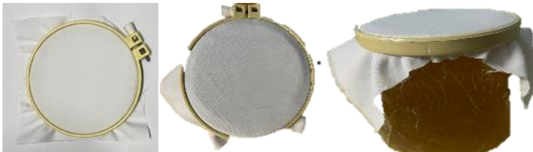
ภาพที่ 48 การขึงผ้าด้วยสติง และนำไปวางบนแบบจำลองเจลลาตินที่เซตตัว
