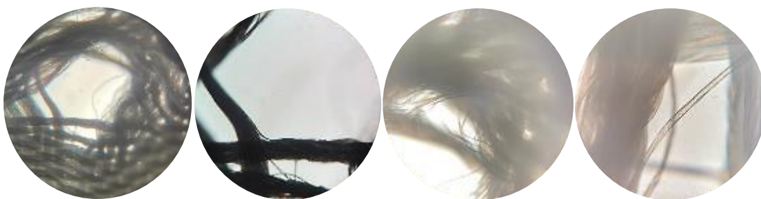
ภาพที่ 107 ขอบของผ้าโพลีเอสเตอร์แบบแห้งที่แห้งด้วยไขควงปากแฉกขนาด 4x(ก), ขนาด 10x(ข) และขนาด 40x(ค) และง
