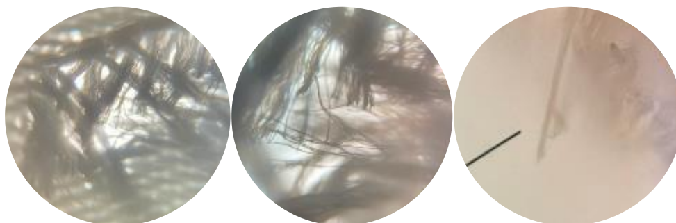
ภาพที่ 98 ขอบบนของผ้าโพลีเอสเตอร์แบบแห้งที่แห้งด้วยมิตครีวขนาด 4x(ก), ขนาด 10x(ข) และขนาด 40x(ค)
