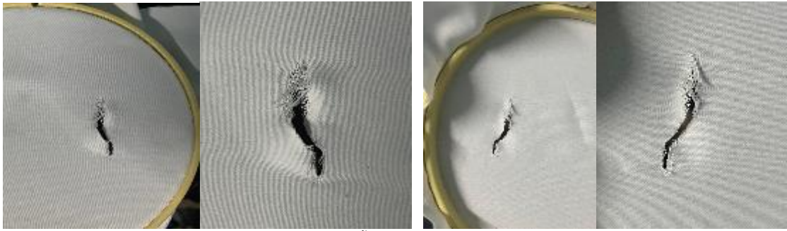
ภาพที่ 70 ความเสียหายบนผ้าโพลีเอสเตอร์แบบที่ผ่านการจุ่มน้ำโดยมีดตัดเตอร์กับเทคนิคหน้าผ้า ก และหลังผ้า ข (ขนาด 1.0x และ 2.5x)
