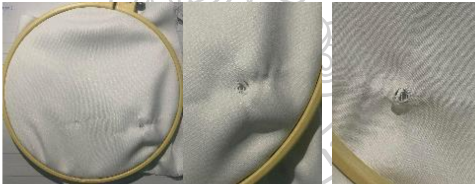
ภาพที่ 67 ความเสียหายบนผ้าโพลีเอสเตอร์แบบแห้งโดยไขควงปากแฉกกับเทคนิคหน้าผ้า ก และหลังผ้า ข (ขนาด 1.0x และ 2.5x)
