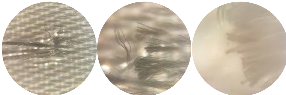
ภาพที่ 113 ขอบล่างของผ้าโพลีเอสเตอร์แบบที่ผ่านการจุ่มน้ำที่แห้งด้วยมิตคิ้วขนาด 4x(ก), ขนาด 10x(ข) และขนาด 40x(ค)
