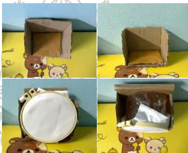
ภาพที่ 49 บล็อกที่ใช้ในการควบคุมไม่ให้แบบจำลองเจลลาตินและตัวอย่างขยับหรือเคลื่อนไปมา และได้มีการจัดตำแหน่งองศาที่เหมาะสมกับการแทง 90 องศาแนวขนาดกัพื้นที่
