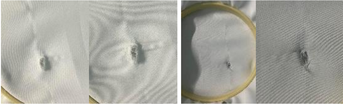
ภาพที่ 66 ความเสียหายบนผ้าโพลีเอสเตอร์แบบแห้งโดยกรรไกรปิดใบมีดกับเทคนิคหน้าผ้า ก และหลังผ้า ข (ขนาด 1.0x และ 2.5x)
