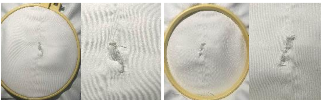
ภาพที่ 65 ความเสียหายบนผ้าโพลีเอสเตอร์แบบแห้งโดยมีดคัตเตอร์กับเทคนิคหน้าผ้า ก และหลังผ้า ข (ขนาด 1.0x และ 2.5x)
