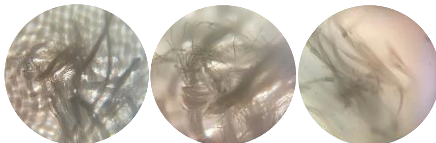
ภาพที่ 104 ขอบกลางของผ้าโพลีเอสเตอร์แบบแห้งที่แห้งด้วยกรรไกรขนาด 4x(ก), ขนาด 10x(ข) และขนาด 40x(ค)
