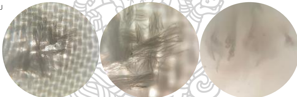
ภาพที่ 106 ขอบล่างของผ้าโพลีเอสเตอร์แบบแห้งที่แห้งด้วยกรรไกรขนาด 4x(ก), ขนาด 10x(ข) และขนาด 40x(ค)
