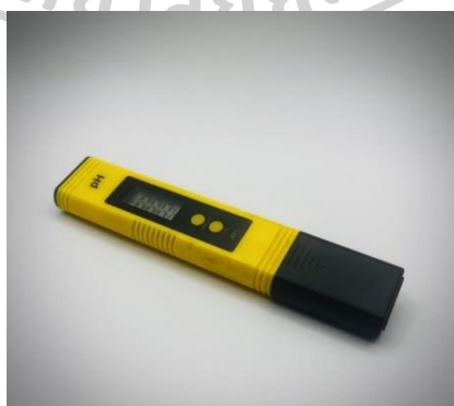
ภาพที่ 15 แสดงลักษณะของเครื่องวัดค่า (pH Meter) เพื่อใช้ในการวัดค่าความเป็นกรด-ด่าง (pH) (Utchin, 2022)
