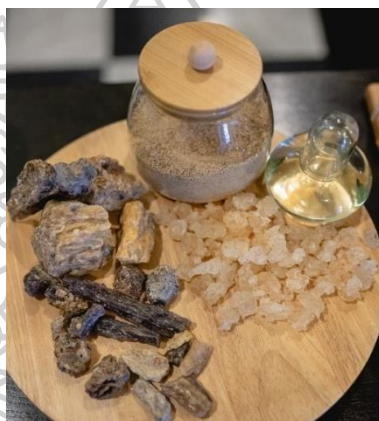
ภาพที่ 52 การแสดงการเตรียมวัสดุอย่างไม้ยางนา, คารายากัม และกลีเซอริน เพื่อสร้างแผ่นใบโอเรชิน สูตรที่ 13.9 (Utchin, 2023)
