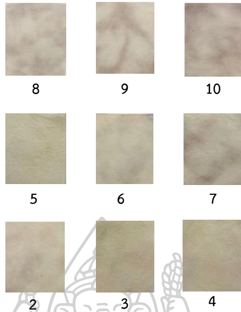
ภาพที่ 69 การย้อมผ้าที่ใช้กระบวนการผงสีกระเจียบด้วยยางไม้จากไปโอเรซิน สูตรที่ 13.9 ย้อมผ้า จำนวน 3 ครั้ง (ซักด้วยน้ำ จำนวน 5 ครั้ง) (Utchin, 2023)
