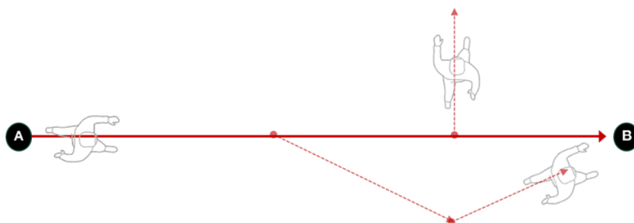
ภาพที่ 183 การเบี่ยงเบนทิศทางระหว่างสัญจรหลักและทางสัญจรย่อย
