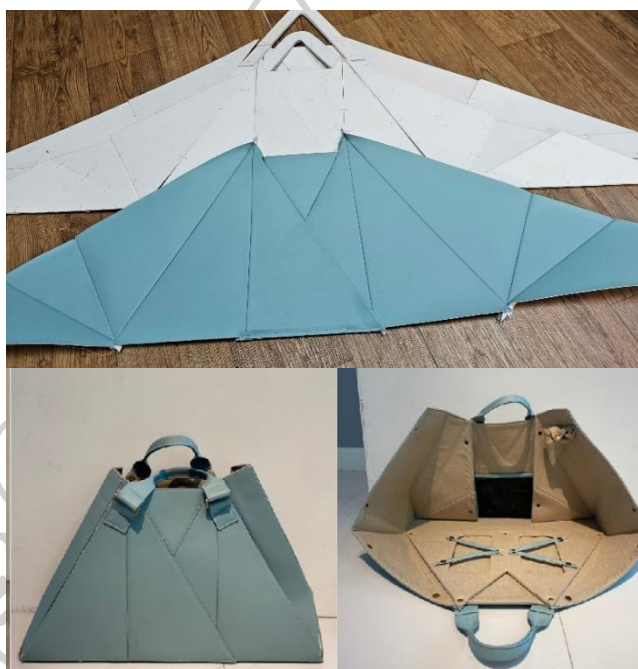
ภาพที่ 117 การพัฒนาแบบจำลองของกระเป๋า “พิบพา” สู่ชิ้นงานจริง
