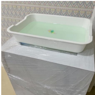
ภาพที่ 18 ภาพฐานตั้งอ่างน้ำที่ใช้ทำการทดลองการกระจายตัวของสีบนผิวน้ำ มีลำโพงด้านหลัง และ วางถาดสี Marbling ด้านบน ภาพโดย ศิฐานิชภัค ศรีพระประแดง, 2566
