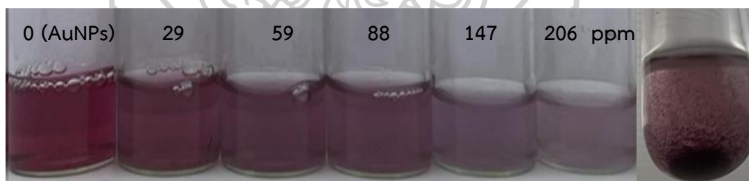
ภาพที่ 34 แสดงการเปลี่ยนแปลงของ AuNPs เมื่อมีการเติม Avermectin ที่มีความเข้มข้นแตกต่างกันและตะกอนที่เกิดขึ้นเมื่อมีการเติม Avermectin
