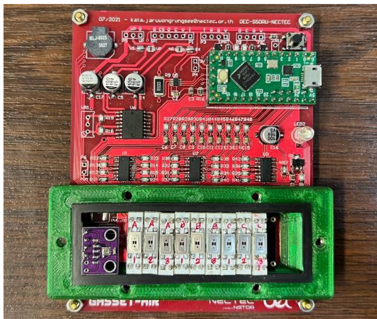
รูปที่ 21 การเชื่อมต่อฐานเซนเซอร์เข้ากับขั้วไฟฟ้าภายในอุปกรณ์รับรู้แก๊ส
