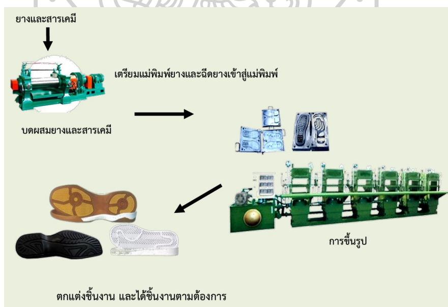
ภาพที่ 7 กระบวนการผลิตยางพื้นรองเท้า
