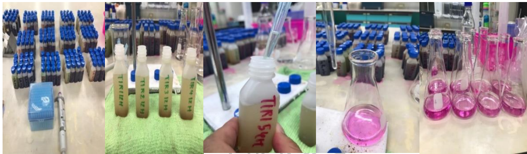
ภาพภาคผนวกที่ 6 การวัดค่าปริมาณกรดแลคติกของน้ำพีชหมักจากใบอ้อย
