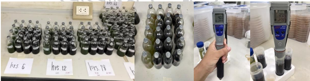
ภาพภาคผนวกที่ 3 การวัดค่า pH ของน้ำพืชหมักจากใบอ้อย
