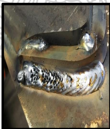
ภาพที่ 1 ตัวอย่างชิ้นงานของเสียที่เกิดจากกระบวนการเชื่อม
