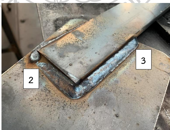
ภาพที่ 37 แสดงแนวเชื่อมหลังปรับปรุงแนวที่ 2 และ 3
