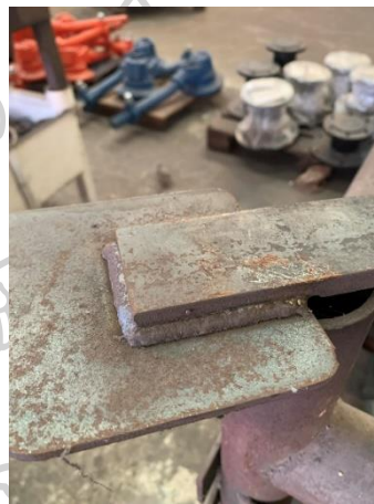
ภาพที่ 24 ตัวอย่างชิ้นงานที่น้ำลวดเชื่อมไม่ซึมผสานกับเนื้อชิ้นงาน
