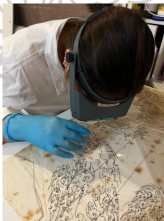
ภาพที่ 28 ภาพการตรวจสอบสภาพโดยใช้แว่นขยายแบบสวมหัว ภาพถ่ายโดยผู้วิจัย, เมื่อวันที่ 20 เมษายน 2566
