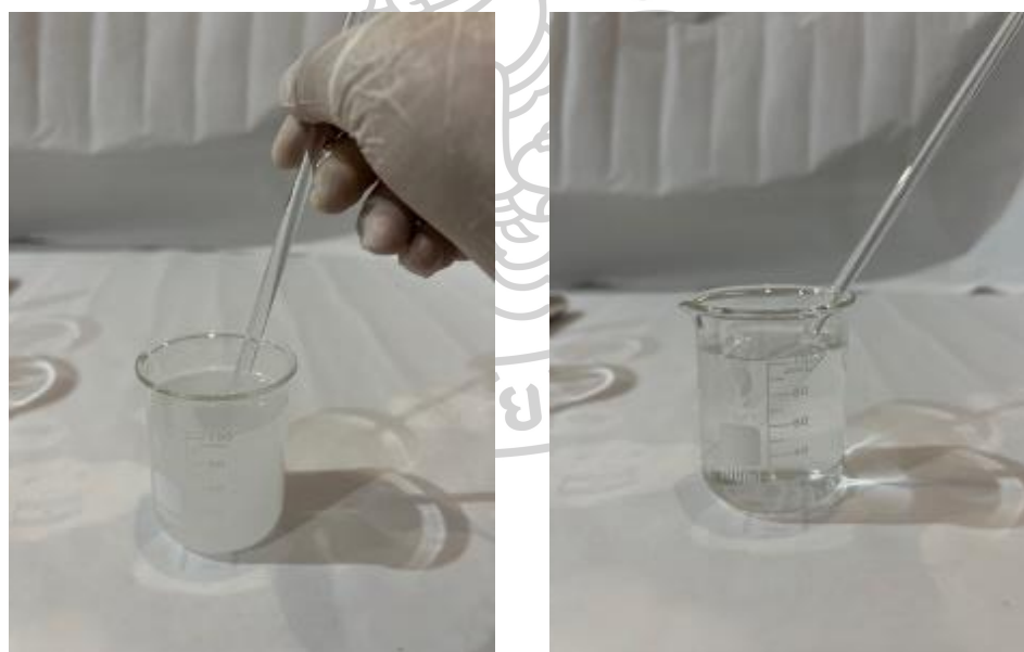
ภาพที่ 50 การผสมสารละลาย กรดเอทิลีนไดเอมีนเตตระอะซิติก ถ่ายโดยผู้วิจัย, เมื่อวันที่ 15 มิถุนายน 2566
