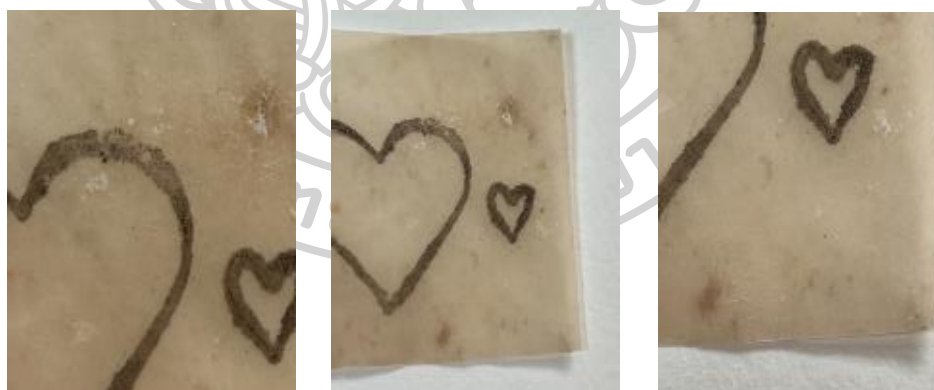
ภาพที่ 86 ภาพรายละเอียดของกระดาษไขเมื่อทดลอง กรดเอทิลีนไดเอมีนเตตระอะซิติก 8% จำนวน 6 ครั้ง ครั้งละ 3 นาที
