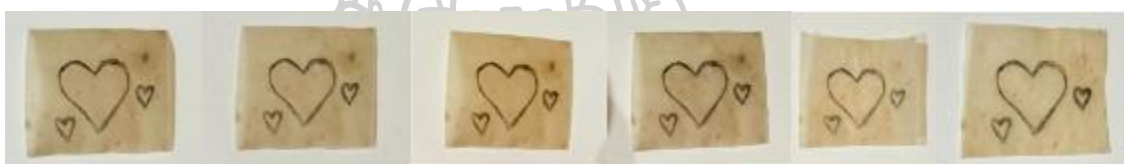
ภาพที่ 85 ภาพการทดลอง กรดเอทิลีนไดเอมีนเตตระอะซิติก 8% จำนวน 6 ครั้ง ครั้งละ 3 นาที
