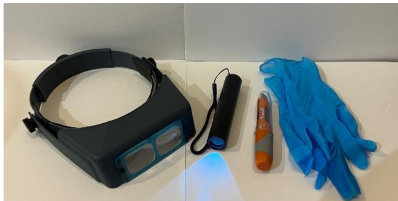
ภาพที่ 27 ภาพอุปกรณ์การตรวจสอบสภาพ ถ่ายโดยผู้วิจัย, เมื่อวันที่ 17 เมษายน 2566
