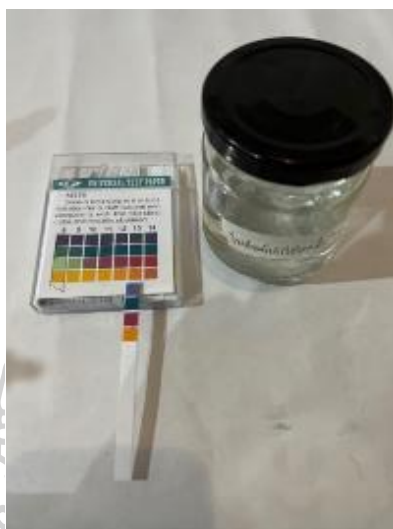
ภาพที่ 53 ค่าความเป็นกรด - ต่างของ โซเดียมโบโรไฮไดรด์ ถ่ายโดยผู้วิจัย, เมื่อวันที่ 15 มิถุนายน 2566
