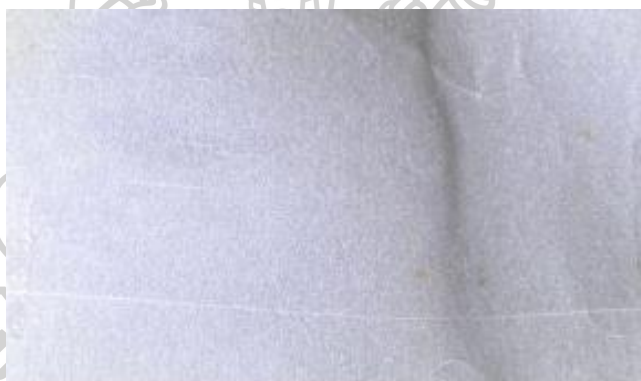
ภาพที่ 89 ภาพกระดาษไขหลังทดสอบด้วย ไฮโดรเจนเปอร์ออกไซด์ 50 กรัม ถ่ายโดยผู้วิจัย, เมื่อวันที่ 30 กันยายน 2566
