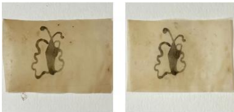
ภาพที่ 72 ภาพก่อนและหลังการทดลอง ของไฮโดรเจนเปอร์ออกไซด์ 7% จำนวน 6 ครั้ง ครั้งละ 3 นาที ถ่ายโดยผู้วิจัย, เมื่อวันที่ 30 กันยายน 2566
