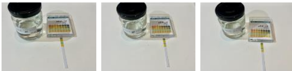
ภาพที่ 67 ภาพการวัดค่าความเป็นกรด-ด่าง ถ่ายโดยผู้วิจัย, เมื่อวันที่ 30 กันยายน 2566
