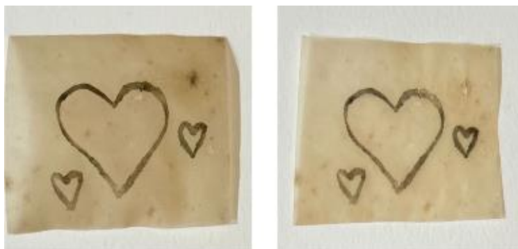
ภาพที่ 84 ภาพก่อนและหลังการทดลอง กรดเอทิลีนไดเอมีนเตตระอะซิติก 8% จำนวน 6 ครั้ง ครั้งละ 3 นาที
