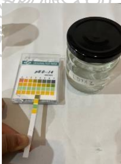
ภาพที่ 54 ค่า ความเป็นกรด - ต่างของ กรดเอทิลีนไดเอมีนเตตระอะซีติก ถ่ายโดยผู้วิจัย, เมื่อวันที่ 15 มิถุนายน 2566
