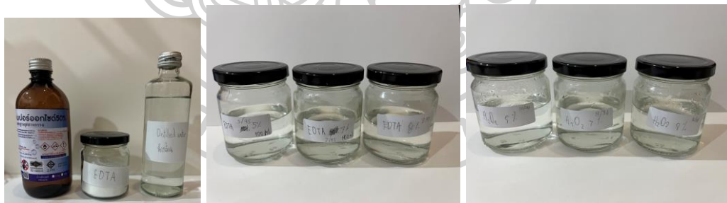
ภาพที่ 64 ภาพการผสมสารละลาย สองชนิด คือ กรดเอทิลีนไดเอมีนเตตระอะซิติก และ ไฮโดรเจนเปอร์ออกไซด์
