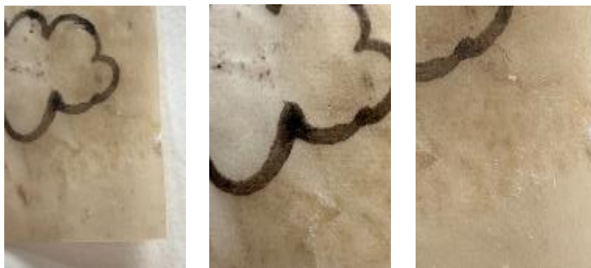
ภาพที่ 77 ภาพรายละเอียดของกระดาษไขเมื่อทดลองด้วยไฮโดรเจนเปอร์ออกไซด์ 8% จำนวน 6 ครั้ง ครั้งละ 3 นาที ถ่ายโดยผู้วิจัย, เมื่อวันที่ 30 กันยายน 2566
