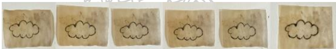
ภาพที่ 75 ภาพก่อนและหลังการทดลอง ของไฮโดรเจนเปอร์ออกไซด์ 8% จำนวน 6 ครั้ง ครั้งละ 3 นาที ถ่ายโดยผู้วิจัย, เมื่อวันที่ 30 กันยายน 2566
