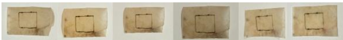
ภาพที่ 79 ภาพการทดลอง กรดเอทิลีนไดเอมีนเตตระอะซิติก 5% จำนวน 6 ครั้ง ครั้งละ 3 นาที ถ่ายโดยผู้วิจัย, เมื่อวันที่ 30 กันยายน 2566
