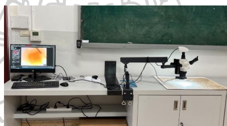
ภาพที่ 31 ภาพการตรวจสอบสภาพผลงานด้วยกล้องจุลทรรศน์ (Microscope) ยี่ห้อ Leica รุ่น S60 Stereo zoom 0.63x – 4.0x Leica DMC2900 Camera & SW kit ถ่ายโดยผู้วิจัย, เมื่อวันที่ 22 พฤษภาคม 2566
