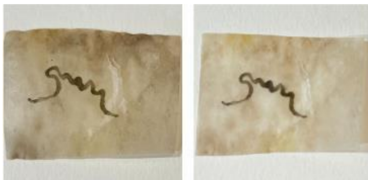
ภาพที่ 69 ภาพก่อนและหลังการทดลอง ของไฮโดรเจนเปอร์ออกไซด์ 5% จำนวน 6 ครั้ง ครั้งละ 3 นาที ถ่ายโดยผู้วิจัย, เมื่อวันที่ 30 กันยายน 2566
