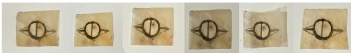
ภาพที่ 82 ภาพการทดลอง กรดเอทิลีนไดเอมีนเตตระอะซิติก 7% จำนวน 6 ครั้ง ครั้งละ 3 นาที ถ่ายโดยผู้วิจัย, เมื่อวันที่ 30 กันยายน 2566
