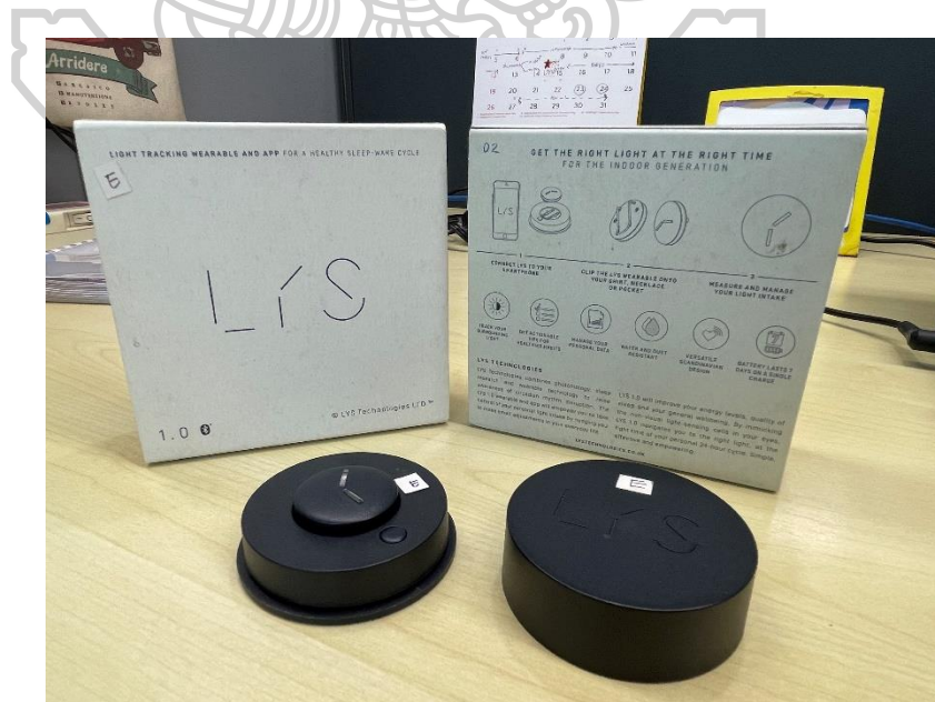
รูปที่ 101 เครื่องมือเซ็นเซอร์และบันทึกการสัมผัสแสงส่องสว่างแบบติดตามตัว (Lys รุ่น 1.0)
