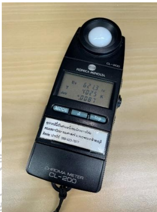
รูปที่ 11 เครื่องวัดแสงและอุณหภูมิแสง Chroma Meter CL-200 Konica Minolta ที่มา : ผู้วิจัย, 2566
