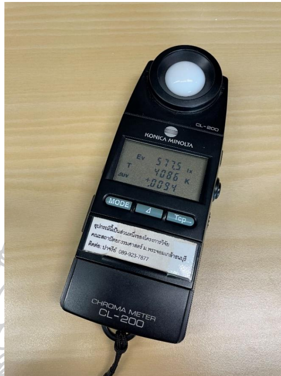
รูปที่ 100 เครื่องวัดแสงและอุณหภูมิแสง Chroma Meter CL-200 Konica Minolta
