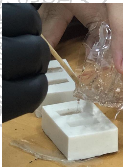
ภาพที่ 16 เทเรซินลงในบล็อกยางพาราที่มี sample 1 ขึ้นต่อ1ช่อง จนเต็ม ที่มา : ถ่ายโดยผู้วิจัย, เมื่อวันที่ 6 ส.ค 2566
