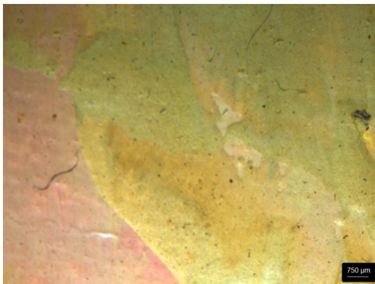
ภาพที่ 55 ช่อง 3 พบเศษชิ้นส่วนขนาดเล็กปนกับเนื้อสี ที่มา : ถ่ายโดยผู้วิจัย, เมื่อวันที่ 6 ส.ค 2566
