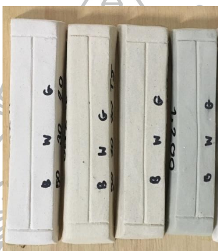
ภาพที่ 19 ผลการทดลองเนื้อดินครั้งที่ 3 สูตรที่ 1-4 เรียงจากซ้ายไปขวา
