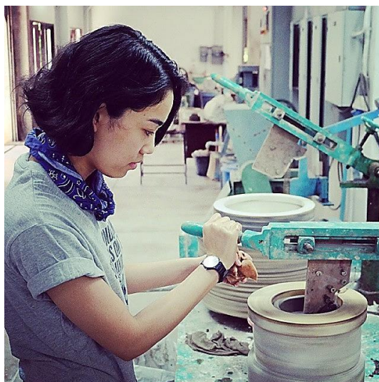
ภาพที่ 12 การขึ้นรูปด้วยการอัดด้วยใบมีด (Jigger)
