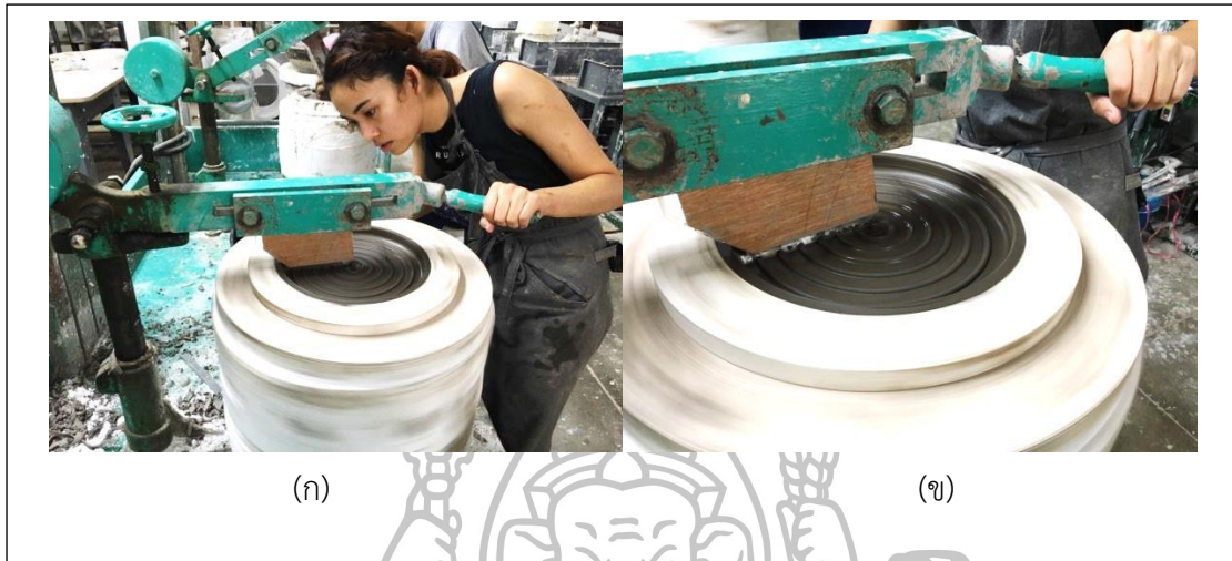
ภาพที่ 41 การผลิตด้วยเครื่อง Jigger
