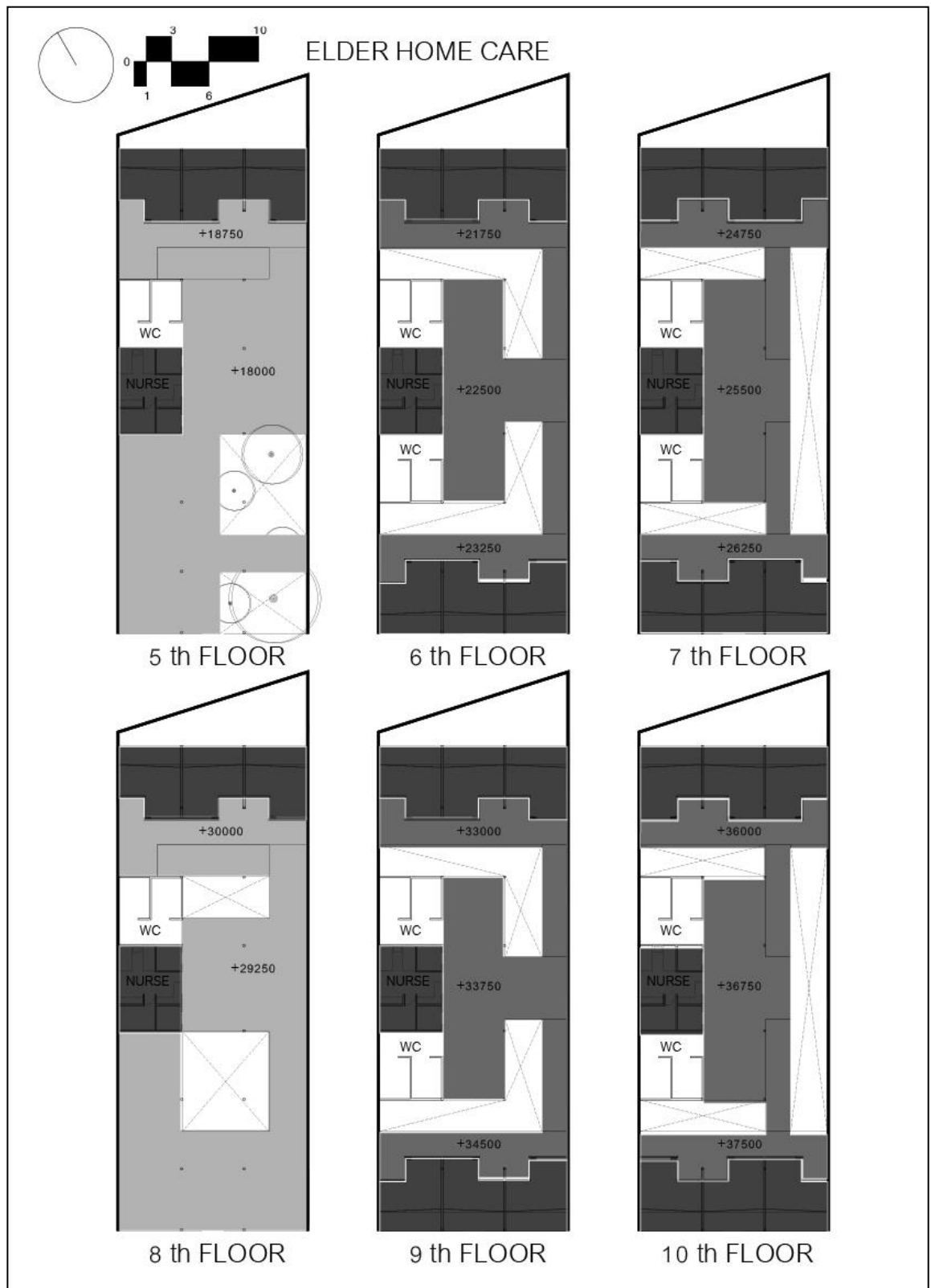
ภาพที่ 43 ผังพื้นบ้านพักคนชราแสดงลักษณะการใช้งานของพื้นที่ส่วนต่างๆในเงื่อนไขความเป็น ส่วนตัว ชั้นที่ 5-10
