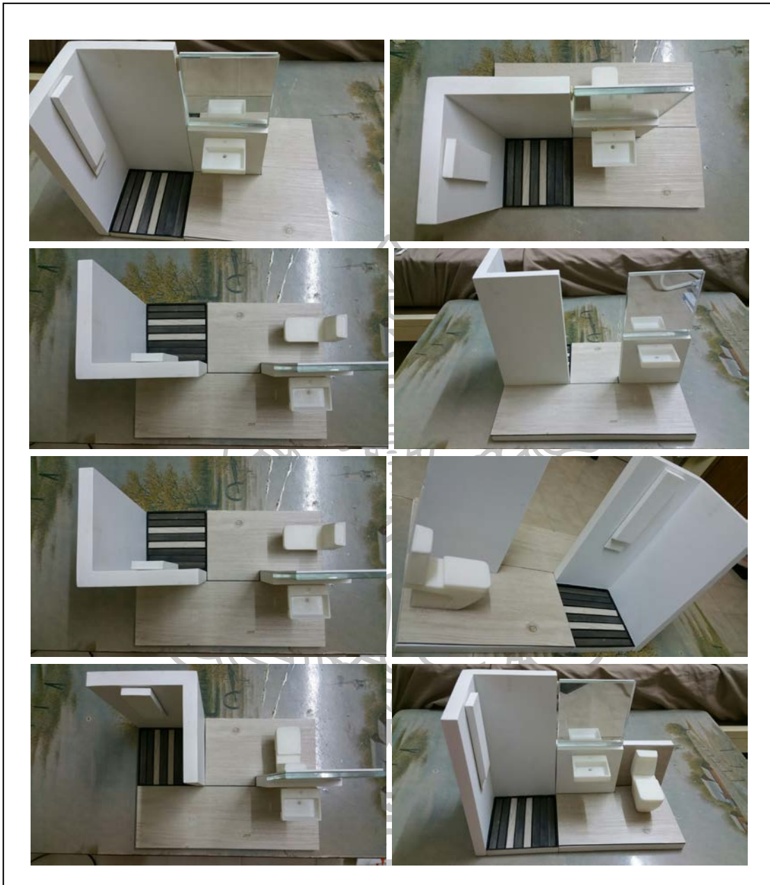
ภาพที่ 40 แสดงภาพจำลอง การจัดวางรูปแบบห้องน้ำโดยใช้ระบบ Modular system
