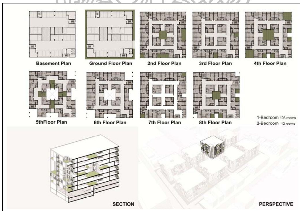
ภาพที่ 84 แผนภาพแสดงรายละเอียดการออกแบบอาคาร 6 ในการออกแบบครั้งสุดท้าย
