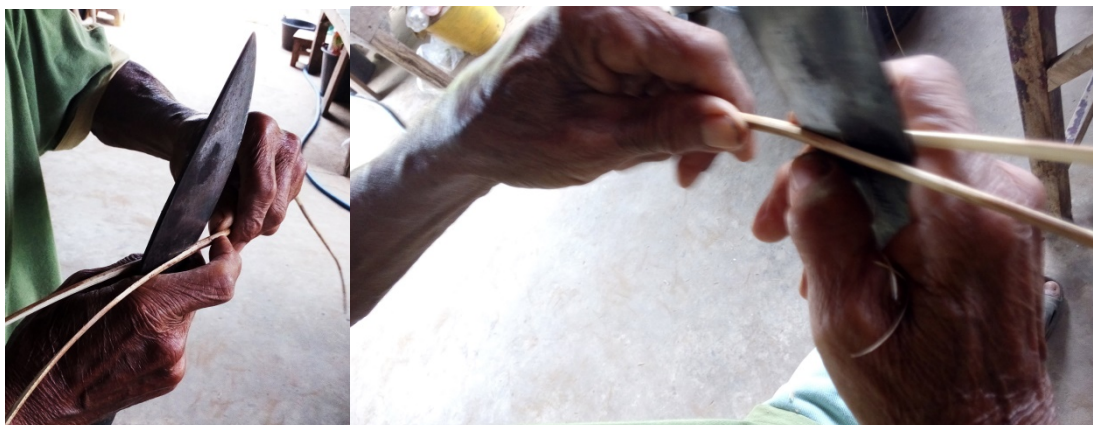
ภาพที่ 25 การผ่าแบ่งต้นหวายออกเป็นส่วนๆ ตามขนาดที่ต้องการ
