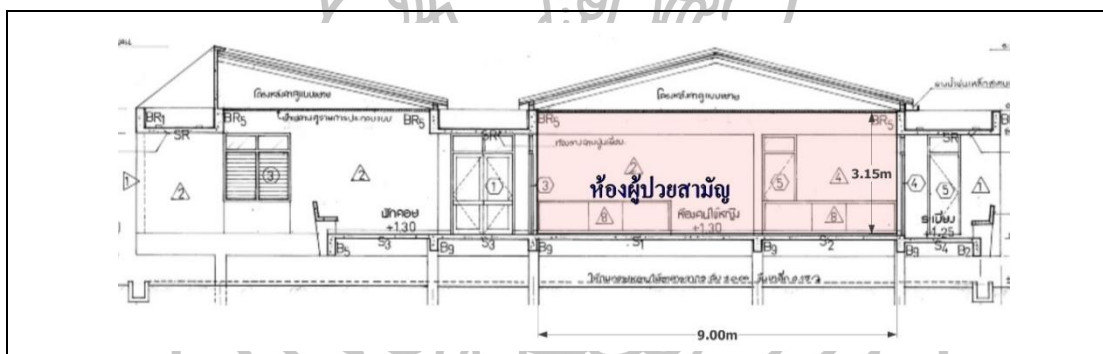
ภาพที่ 60 แสดงรูปตัดอาคารผู้ป่วยในแสดงความสูงฝ้าเพดาน
