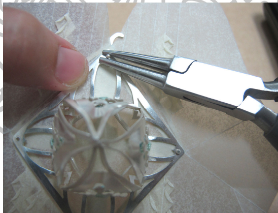
ภาพที่ 77 วิธีการตอกหมุดเพื่อยึดโลหะและกระดาดเข้าด้วยกัน
