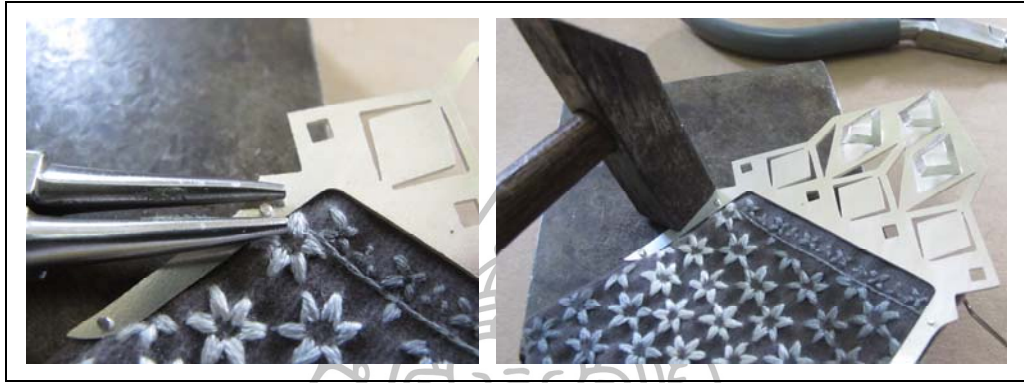
ภาพที่ 66 วิธีการตอกหมุดเพื่อยึดติดตัวเรือนของเครื่องประดับตำแหน่งปกสูท (เข็มกลัด)
