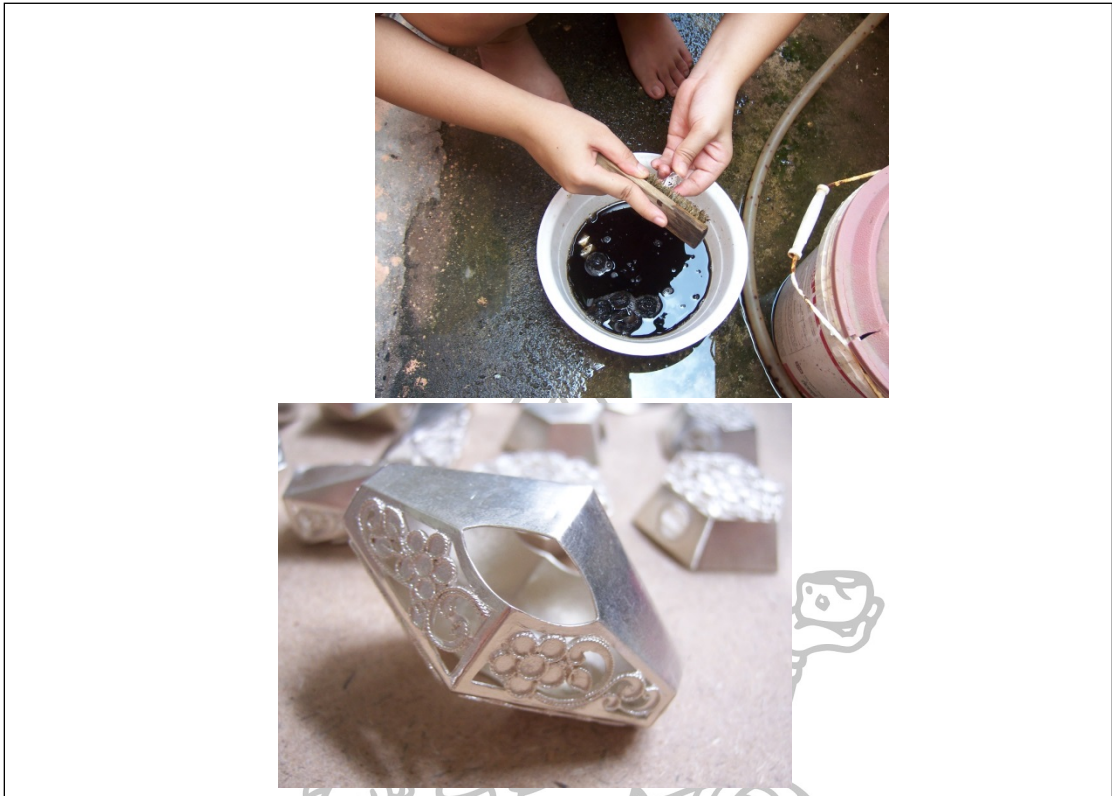
ภาพที่ 110 การทำความสะอาดชิ้นงานก่อนนำไปชุบเคลือบผิวหรือลงยาสี
