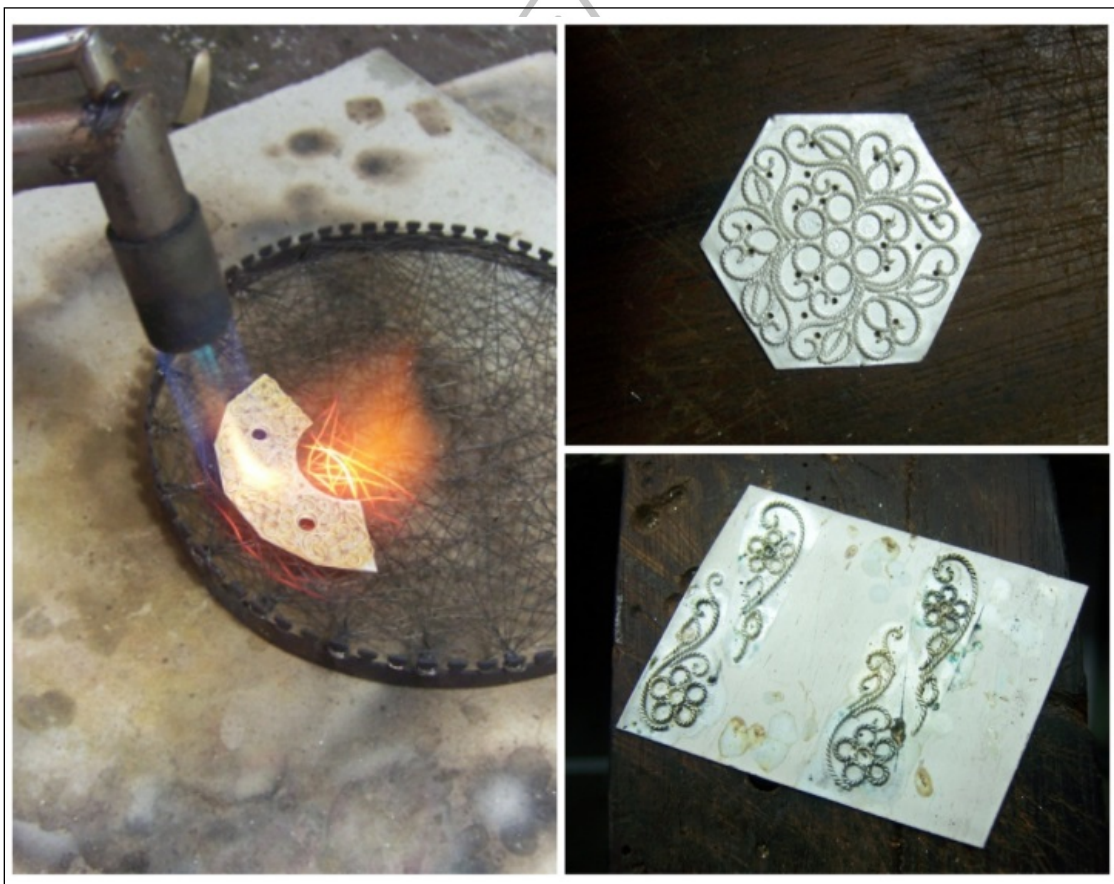
ภาพที่ 104 การเชื่อมลายติดบนแผ่นโลหะ
