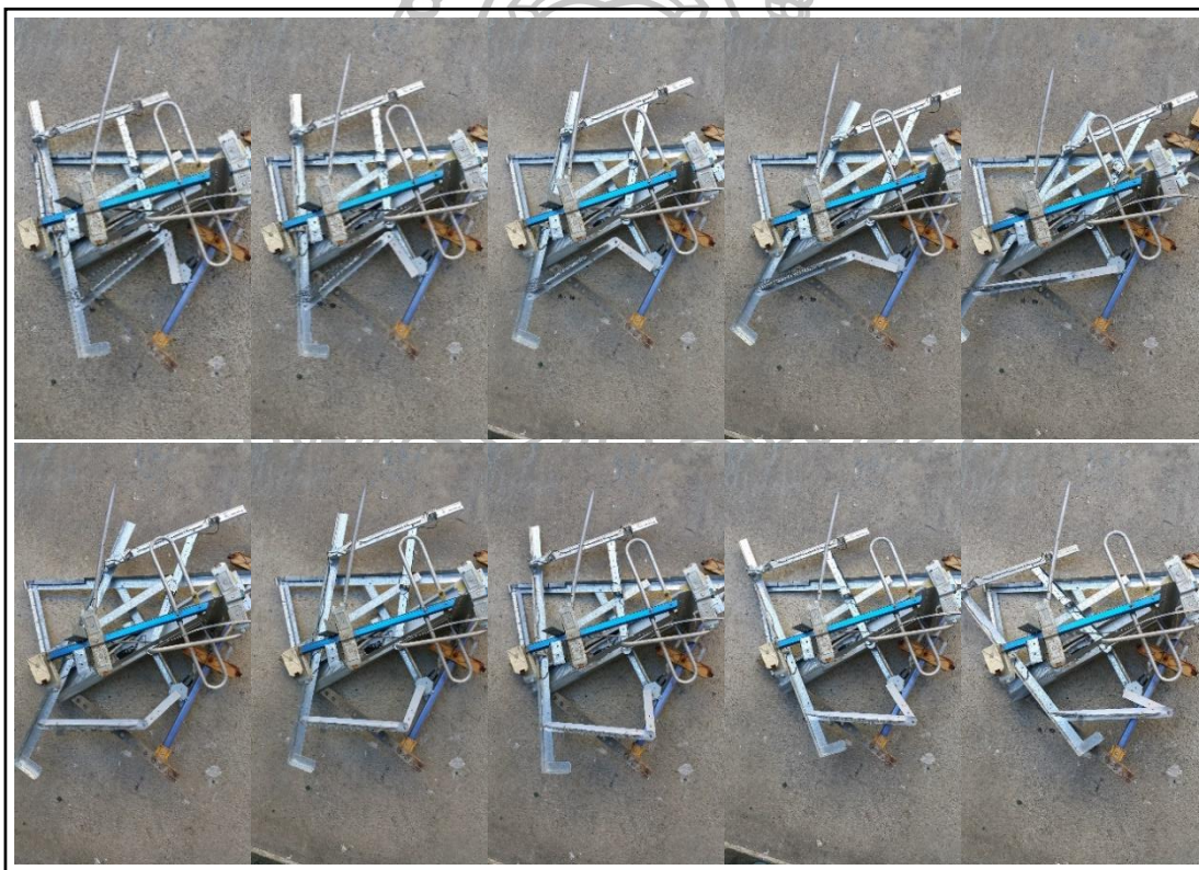
ภาพที่ 9 ภาพการเคลื่อนไหวของแกนกลไกมอเตอร์
