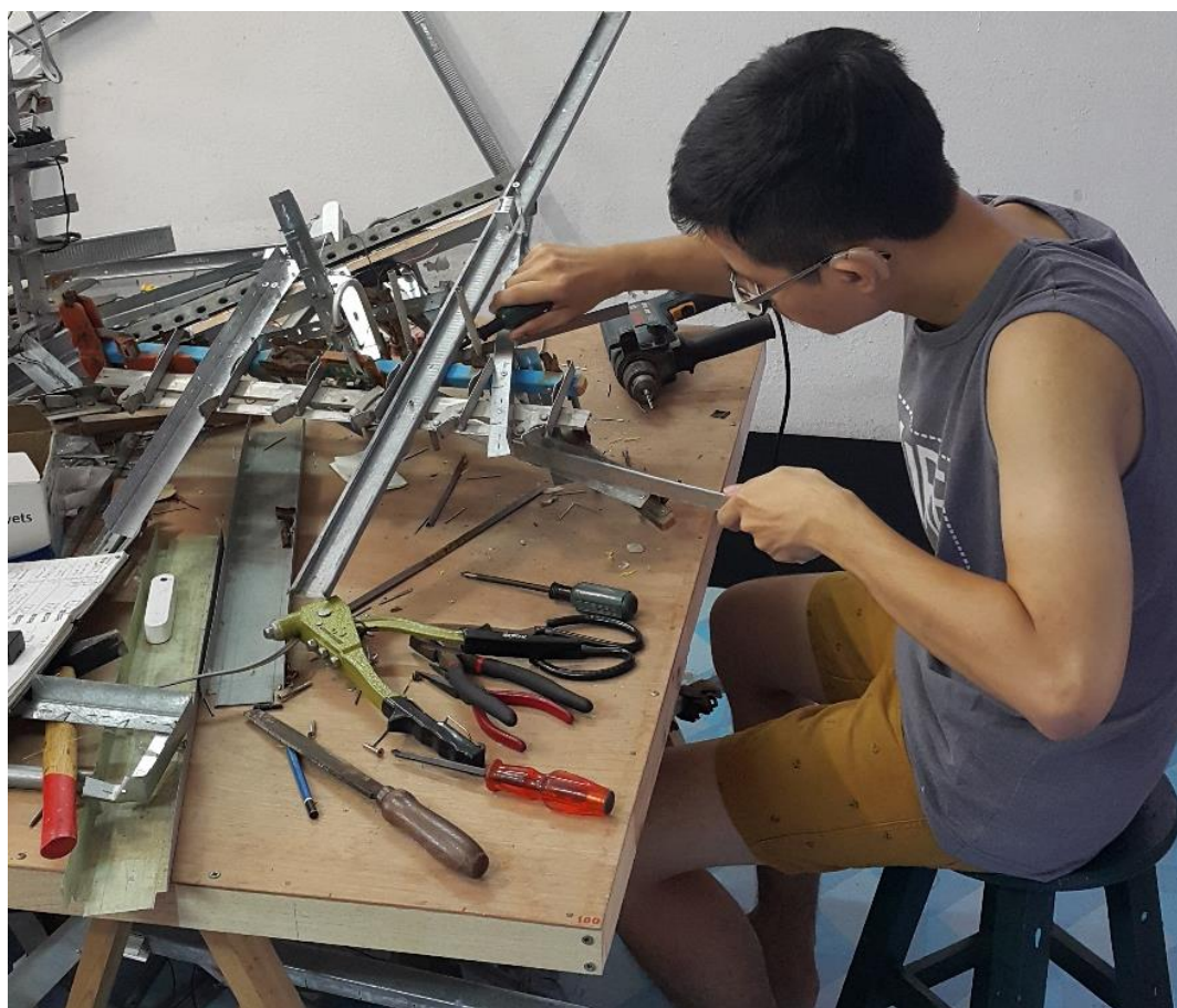
ภาพที่ 24 ภาพขั้นตอนการสร้างสรรค์ผลงาน ส่วนการต่อแกนกลไกมอเตอร์
