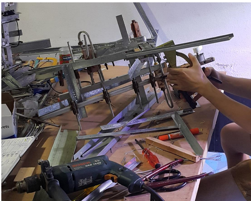
ภาพที่ 22 ภาพขั้นตอนการสร้างสรรค์ผลงาน ส่วนการเชื่อมวัสดุด้วยรีเวท
