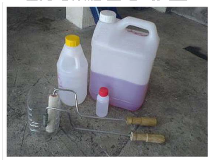
ภาพที่ 104 ภาพน้ำยาเรซินและตัวช่วยเร่งปฏิกิริยา หรือ ตัวทำให้แข็ง
