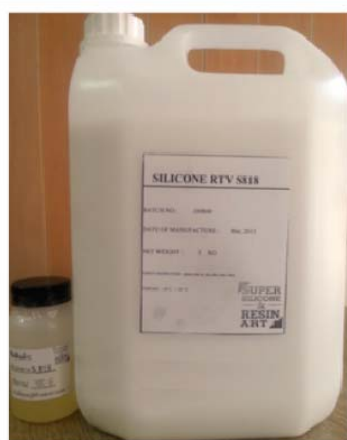
ภาพที่ 97 ภาพยางซิลิโคนที่ใช้ในการทำแม่พิมพ์
