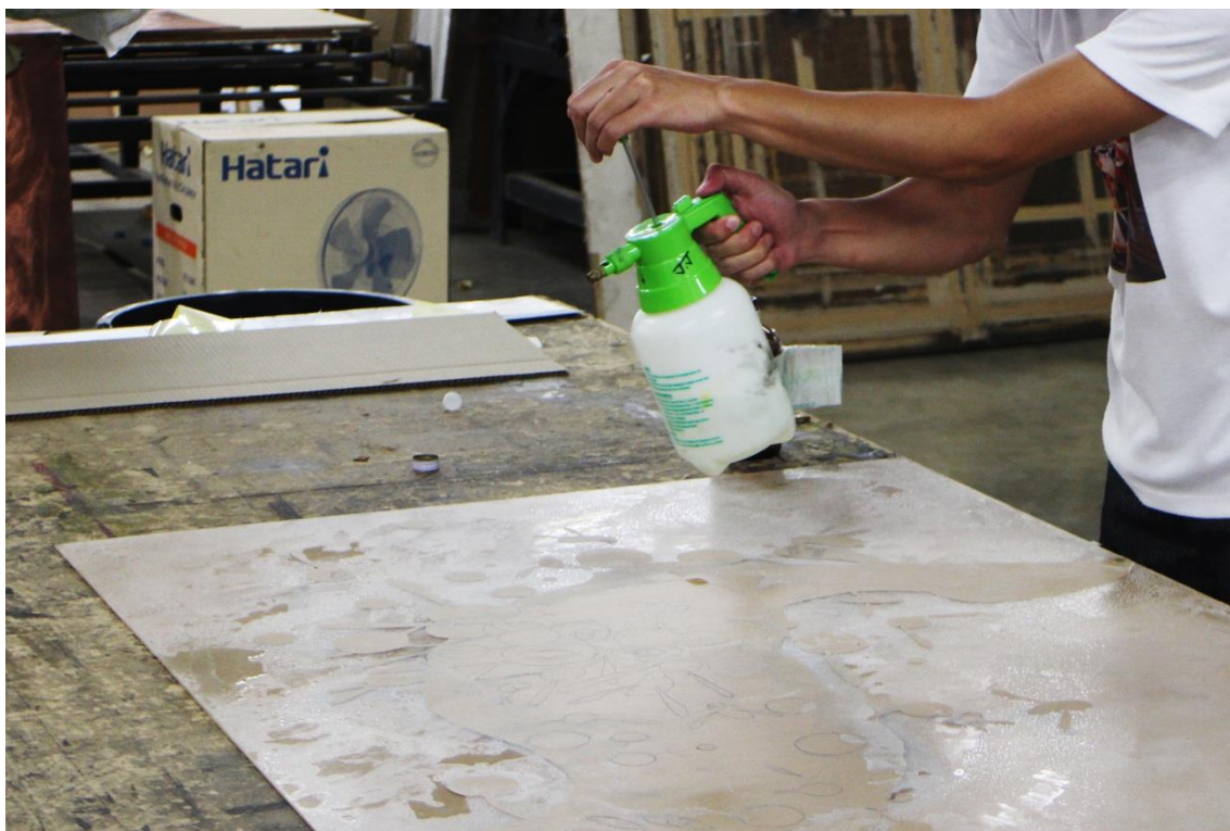
ภาพที่ 13 ขั้นตอนการเทน้ำยาเชื่อมอะคริลิก แล้วจึงฉีดน้ำ เพื่อสร้างพื้นผิว และน้ำหนักร
