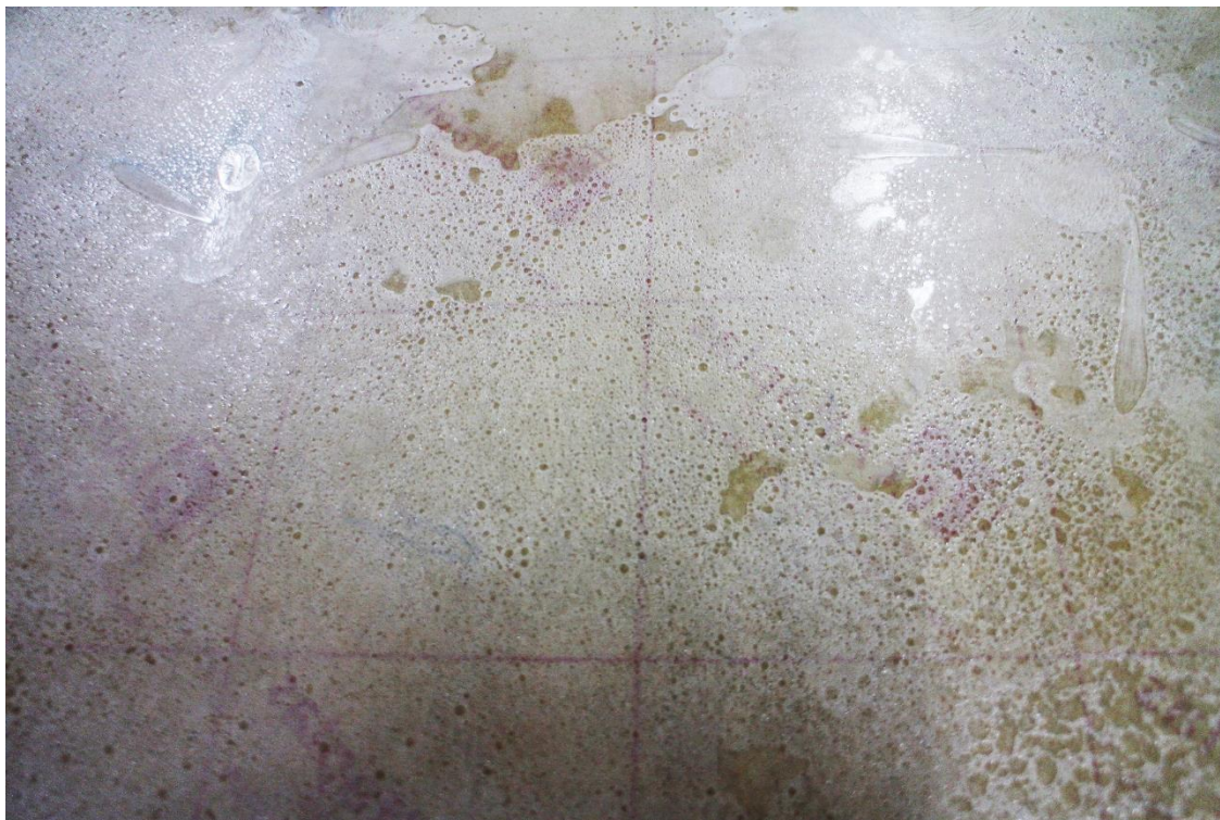
ภาพที่ 14 แม่พิมพ์ที่ผ่านการสร้างน้ำหนักด้วยน้ำยาเชื่อมอะคริลิก
