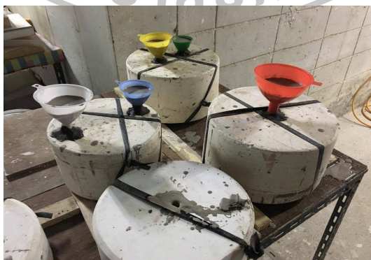
ภาพที่ 44 ภาพการหล่อชิ้นงานแบบหล่อต้น (ภาพถ่ายโดย นายประธาน เลิศงาม)
