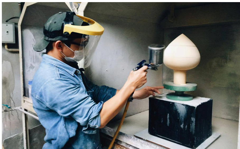
ภาพที่ 47 ภาพการพ่นเคลือบชิ้นงานด้วยกาพ่นเคลือบ (ภาพถ่ายโดย นายประธาน เลิศงาม)
