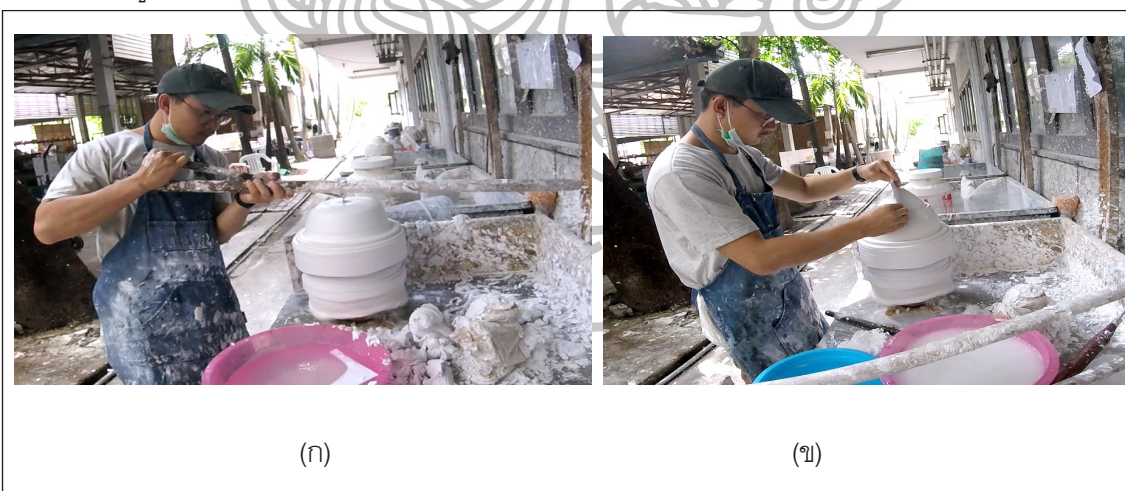
ภาพที่ 14 การสร้างต้นแบบด้วยวิธีการกลึงปูนปลาสเตอร์
