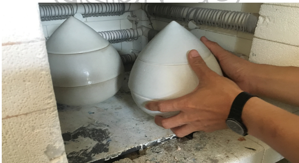
ภาพที่ 50 ภาพการนำชิ้นงานออกจากเตาเผาเคลือบ (ภาพถ่ายโดย นายประธาน เลิศงาม)
