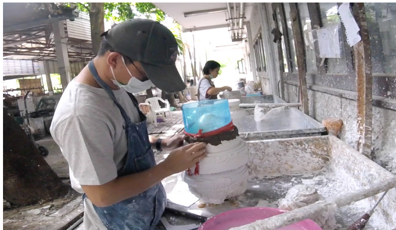
ภาพที่ 43 ภาพการกันแผ่นพลาสติก เพื่อเทปูนพลาสติกเตอร์สำหรับทำแม่พิมพ์หล่อ (ภาพถ่ายโดย นายประธาน เลิศงาม)
