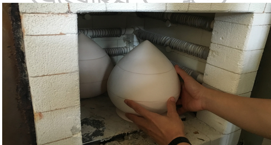
ภาพที่ 46 ภาพการนำชิ้นงานเข้าเผา (ภาพถ่ายโดย นายประธาน เลิศงาม)
