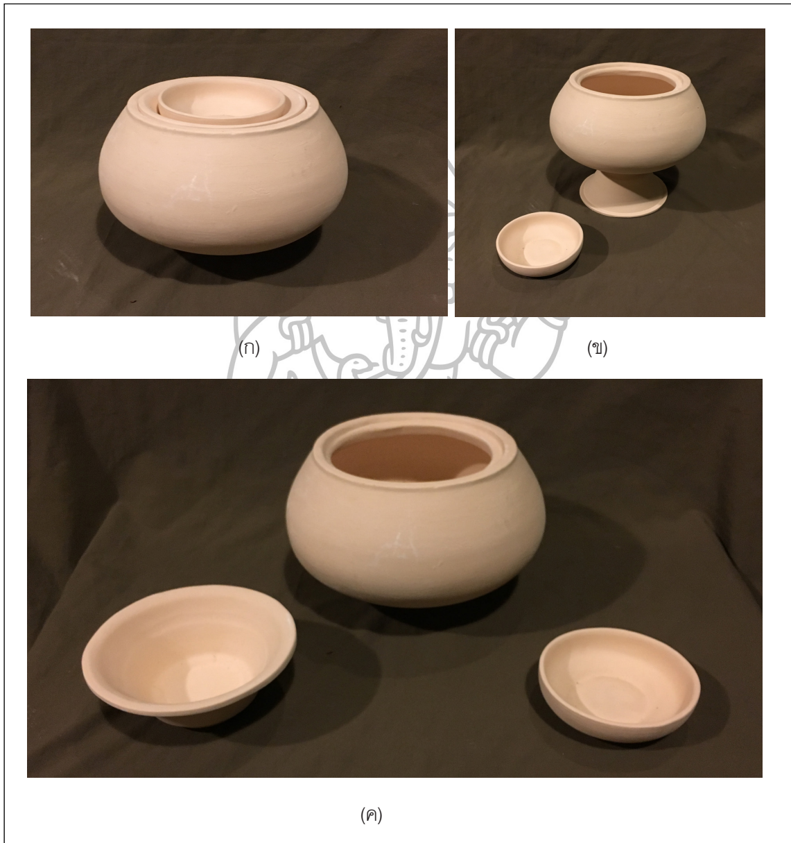
ภาพที่ 33 ภาพสเก็ตซ์ 3 มิติ ขึ้นรูปด้วยการหล่อและเผาที่ 800^{\circ}\text{C} (ก) สเก็ตซ์ 3 มิติ ขึ้นงานซ้อนกัน (ข) สเก็ตซ์ 3 มิติ แยกชิ้นงานออกจากกัน (ค) สเก็ตซ์ 3 มิติ แยกชิ้นงานออกจากกัน (ภาพถ่ายโดย นายประธาน เลิศงาม)
