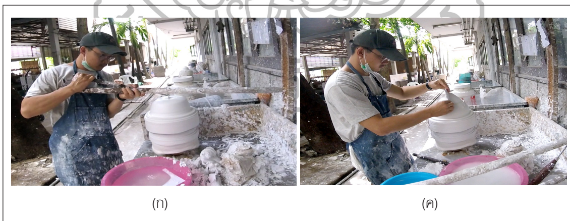
ภาพที่ 42 ภาพการกลึงชิ้นงาน (ก) ภาพการใช้ใบมีดกลึงชิ้นงาน (ค) ภาพการตกแต่งชิ้นงานด้วยกระดาษทราย (ภาพถ่ายโดย นายประธาน เลิศงาม)
