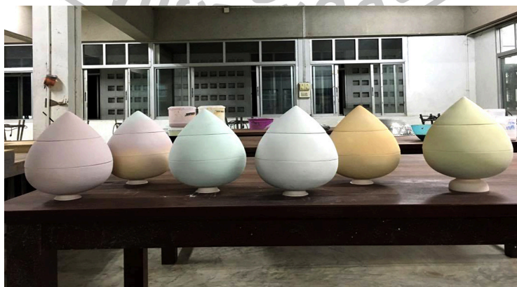
ภาพที่ 48 ภาพการชิ้นงานหลังการพ่นเคลือบ (ภาพถ่ายโดย นายประธาน เลิศงาม)
