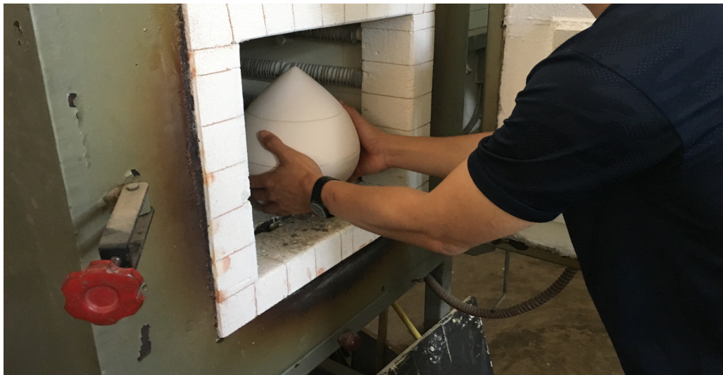
ภาพที่ 49 ภาพการนำชิ้นงานเข้าเตาเผาเคลือบ (ภาพถ่ายโดย นายประธาน เลิศงาม)
