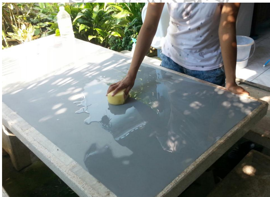
ภาพที่ 15 การล้างเพลทด้วยกรดกำมะถันเพื่อขจัดเขม่าที่ติดกับเพลท
