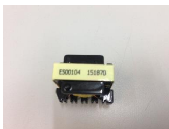
ภาพที่ 4.2 หม้อแปลงที่หุ้มด้วยวัสดุประเภทกระดาษ (ขนาดเล็ก)
