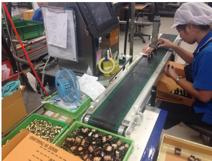
ภาพที่ 4.5 สายพานลำเลียงชิ้นงานขนาดยาว 1.5 เมตร กว้าง 0.2 เมตรควบคุมด้วยระบบมอเตอร์
