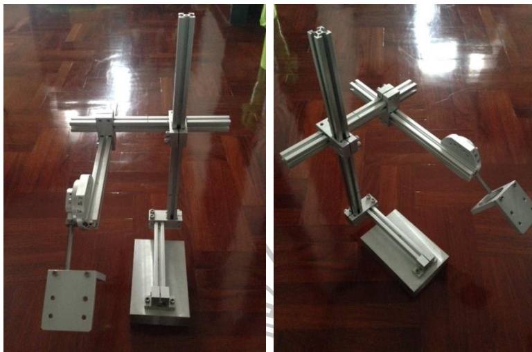
ภาพที่ 4.1 ชุดอุปกรณ์สำหรับการติดตั้งระบบตรวจสอบด้วยภาพ 3 แคน
