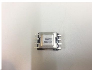
ภาพที่ 4.3 หม้อแปลงที่หุ้มด้วยโลหะ หรือ อะลูมิเนียม (ขนาดเล็ก)
