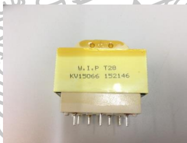
ภาพที่ 4.4 หม้อแปลงที่หุ้มด้วยวัสดุพลาสติก (ขนาดเล็ก)
