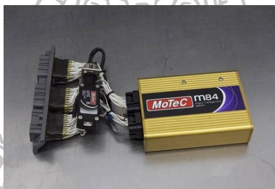
ภาพที่ 18 กล่องควบคุมระบบต่าง ๆ ของรถ หรือ ECU
