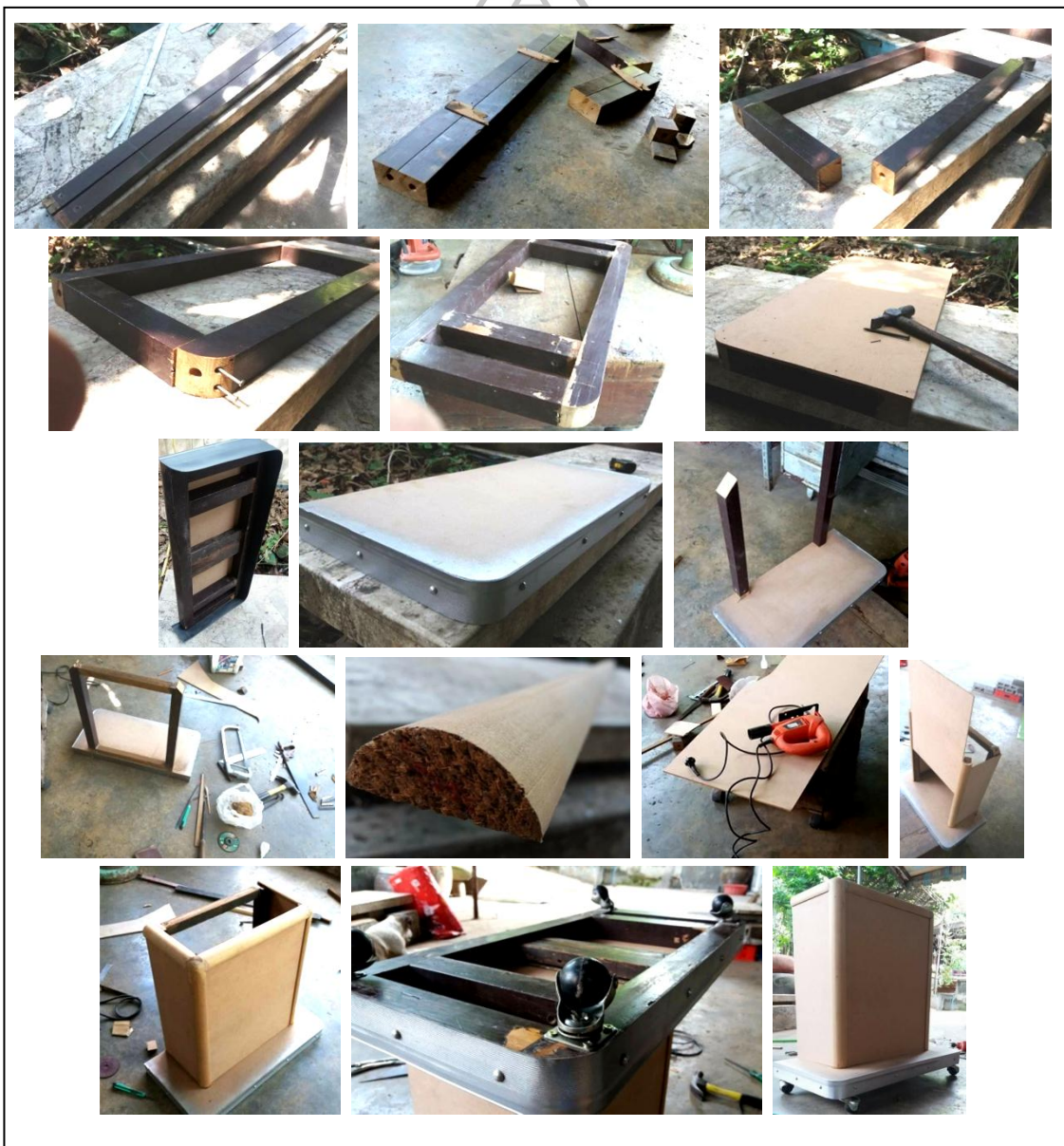
ภาพที่ 33 การประกอบโครงสร้างส่วนล่างผลงานชิ้นที่ 3
