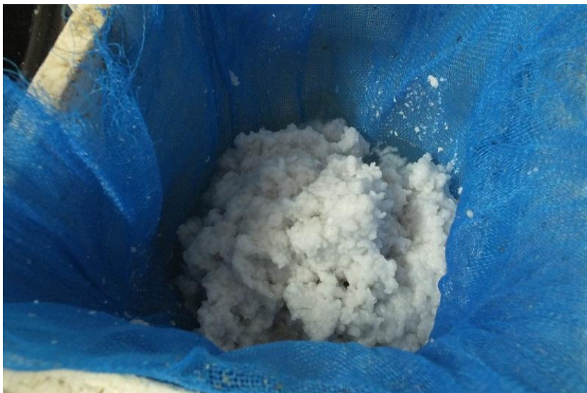
ภาพที่ 35 เมื่อบีบกระดาษละเอียดแล้วต้องนำมาบีบเพื่อนำน้ำออกให้กระดาษมีความชื้นที่มาก ๆ
