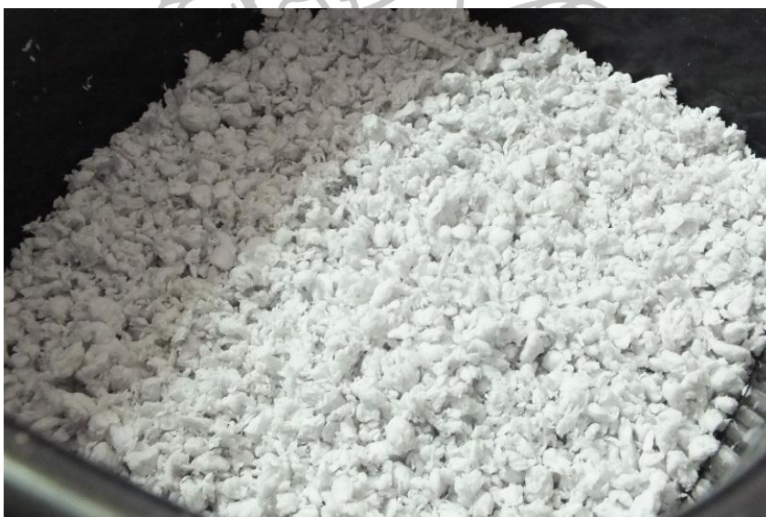
ภาพที่ 36 เมื่อบีบน้ำออกหมดแล้วย่อยกระดาษให้เป็นชิ้นที่ละเอียดให้มากที่สุด ยิ่งย่อยได้ชิ้นเล็กเท่าไรจะสามารถลดระยะเวลาในการนวดกระดาษได้เร็วขึ้น
