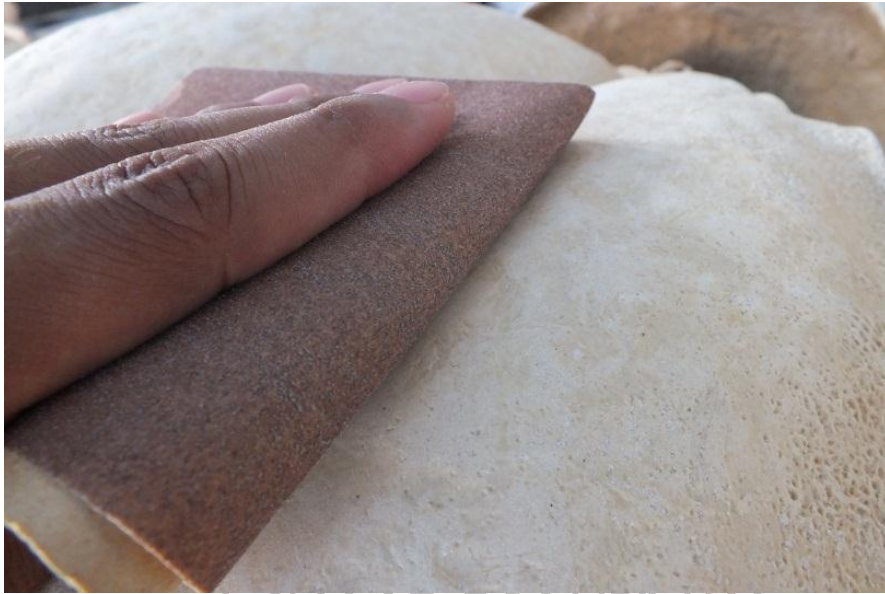
ภาพที่ 51 หลังจากทำพื้นผิวเสร็จแล้วรอชิ้นงานแห้ง แล้วนำชิ้นงานมาขัดด้วยกระดาษทรายเพื่อเน้นพื้นผิวให้โดดเด่นขึ้นมาในจุดที่ต้องการ
