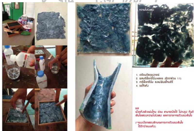
ภาพที่ 134 การทดสอบลักษณะเส้นใยและความโปร่งแสงของไหมอีรีเมื่ออยู่ในของเหลว (อีพ็อกซีนิ่ม) (ถ่ายโดยผู้วิจัย เมื่อวันที่ 30 มีนาคม 2559)
