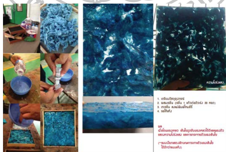
ภาพที่ 132 การทดสอบลักษณะเส้นใยและความโปร่งแสงของไหมอีรี่ เมื่ออยู่ในของเหลว (เรซิ่นแข็ง) (ถ่ายโดยผู้วิจัย เมื่อวันที่ 30 มีนาคม 2559)
