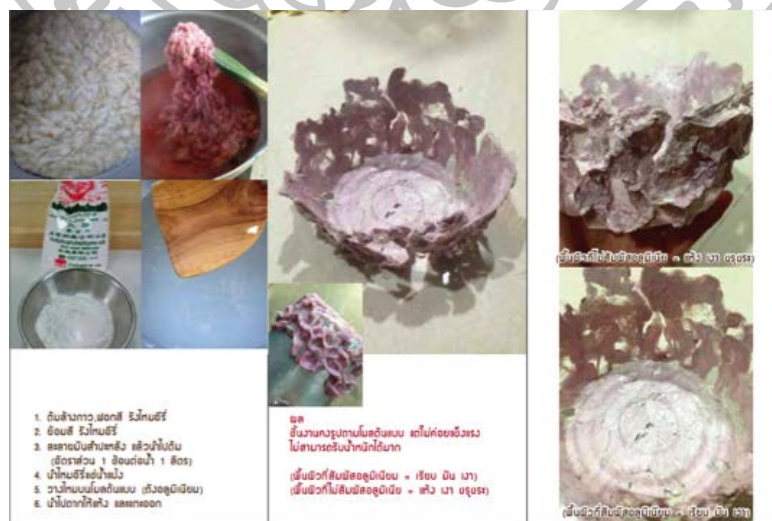
ภาพที่ 127 การทดสอบการเกาะตัวของไหมอีรี (ความแข็งแรง) และผิวสัมผัสแบบแผ่น ด้วยการผสมวัสดุประสาน (น้ำแป้งมันสำปะหลัง) ทดสอบบนแม่พิมพ์ (โมลด์) อลูมิเนียม (ถ่ายโดยผู้วิจัย เมื่อวันที่ 15 มีนาคม 2559)
