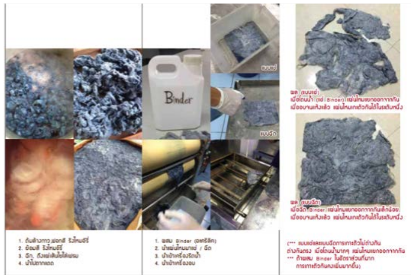
ภาพที่ 124 การทดสอบการเกาะตัวของไหมอีรี่ (ความแข็งแรง) แบบแผ่น ด้วยวิธีการแช่และการฉีด วัสดุประสานอะคริลิก (Binder) (ถ่ายโดยผู้วิจัย เมื่อวันที่ 10 มีนาคม 2559)
