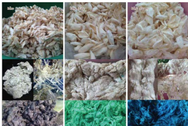
ภาพที่ 119 การทดสอบเนื้อไหม ระหว่างรังไหม, รังไหมชั้นในและรังไหมชั้นนอก และทดสอบการเกาะตัวของเส้นไหม (ถ่ายโดยผู้วิจัย เมื่อวันที่ 28 กุมภาพันธ์ 2559)
