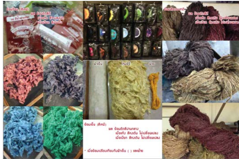
ภาพที่ 121 การทดสอบการย้อมติดสีของเส้นไหมออร์แกนิก โดยการย้อมสีธรรมชาติและสีเคมี (ถ่ายโดยผู้วิจัย เมื่อวันที่ 6 มีนาคม 2559)
