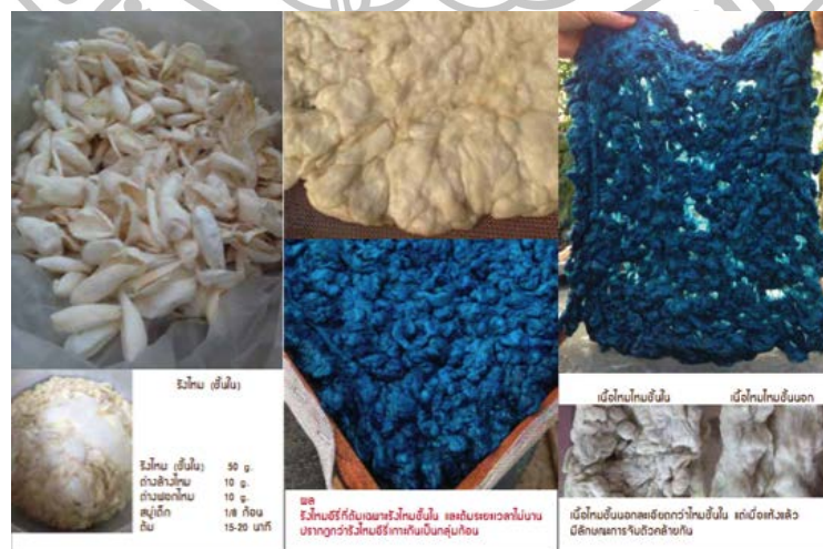
ภาพที่ 122 การทดสอบเนื้อไหมออร์แกนิกของรังไหมชั้นใน โดยใช้ระยะเวลาการต้มลอกกาไหมไม่นาน ประมาณ 15-20 นาที (ถ่ายโดยผู้วิจัย เมื่อวันที่ 8 มีนาคม 2559)
