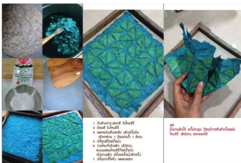
ภาพที่ 128 การทดสอบการพับและการคงรูปของแผ่นไหมอีรี่ที่ผสมวัสดุประสาน (น้ำแป้งมันสำปะหลัง) (ถ่ายโดยผู้วิจัย เมื่อวันที่ 20 มีนาคม 2559)
