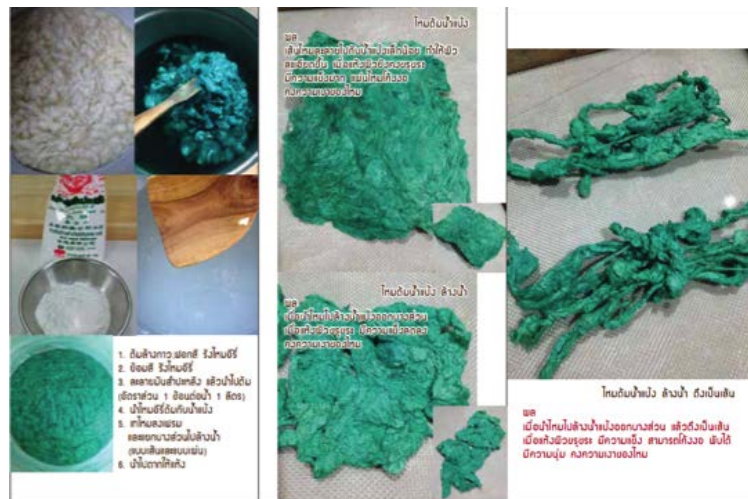
ภาพที่ 129 การทดสอบการเกาะตัว (ความแข็งแรง) ของเส้นไหมอีรี ที่ผสมวัสดุประสาน (น้ำแป้งมันสำปะหลัง) (ถ่ายโดยผู้วิจัย เมื่อวันที่ 20 มีนาคม 2559)
