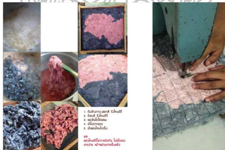
ภาพที่ 125 การทดสอบการเกาะตัวของไหมอีรี่ (ความแข็งแรง) ด้วยวิธีการเย็บ (ถ่ายโดยผู้วิจัย เมื่อวันที่ 11 มีนาคม 2559)
