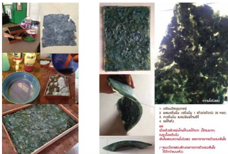
ภาพที่ 133 การทดสอบลักษณะเส้นใยและความโปร่งแสงของไหมอีรี เมื่ออยู่ในของเหลว (เรซินนิ่ม) (ถ่ายโดยผู้วิจัย เมื่อวันที่ 30 มีนาคม 2559)
