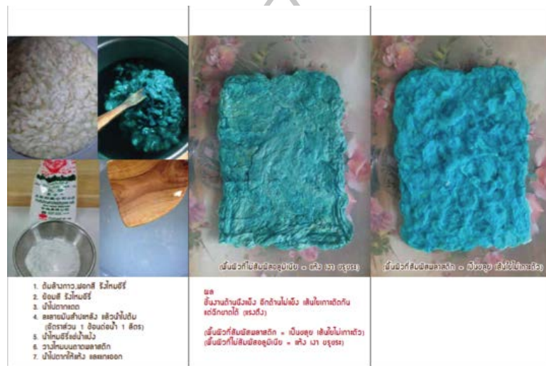
ภาพที่ 126 การทดสอบการเกาะตัวของไหมอีรี (ความแข็งแรง) และผิวสัมผัสแบบแผ่น ด้วยการผสมวัสดุประสาน (น้ำแป้งมันสำปะหลัง) ทดสอบบนแผ่นพลาสติก (ถ่ายโดยผู้วิจัย เมื่อวันที่ 15 มีนาคม 2559)
