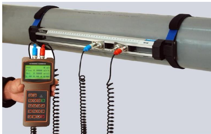
ภาพที่ 2.12 Flow meter ตรวจวัดอัตราการไหล
