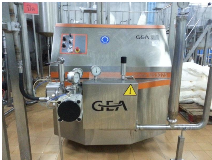
ภาพที่ 3.19 เครื่อง Homo GEA ของโรงงานตัวอย่าง
