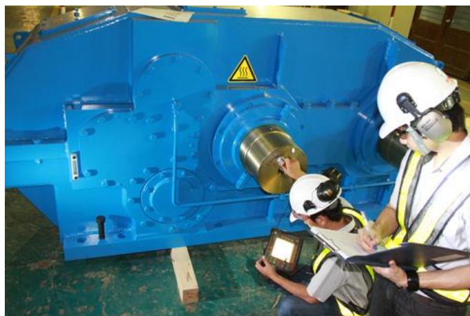
ภาพที่ 2.10 การวัดเสียงจากเครื่องจักรโดย Stethoscope
