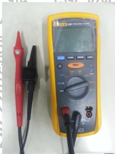
ภาพที่ 3.37 เครื่องมือตรวจสอบค่าความเป็นฉนวนของมอเตอร์
