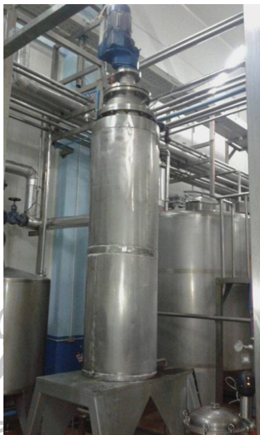
ภาพที่ 3.4 เครื่องให้ความร้อนตั้งต้น (Preheat)
