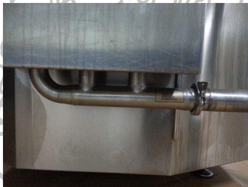
ภาพที่ 3.25 ส่วนประกอบย่อยของชุด Manifold Group
