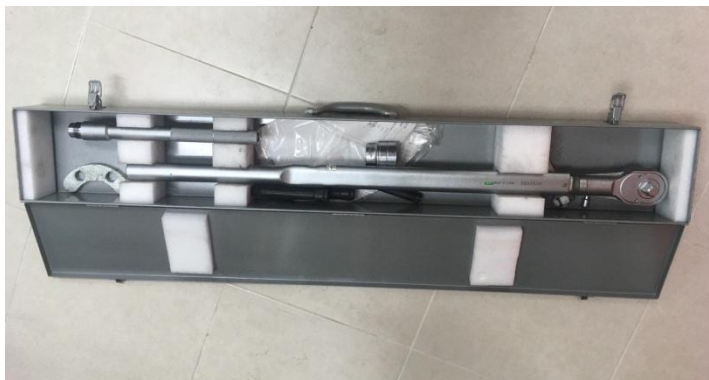
ภาพที่ 3.38 เครื่องมือตรวจสอบการหลวมคลอนและการขันแน่น
