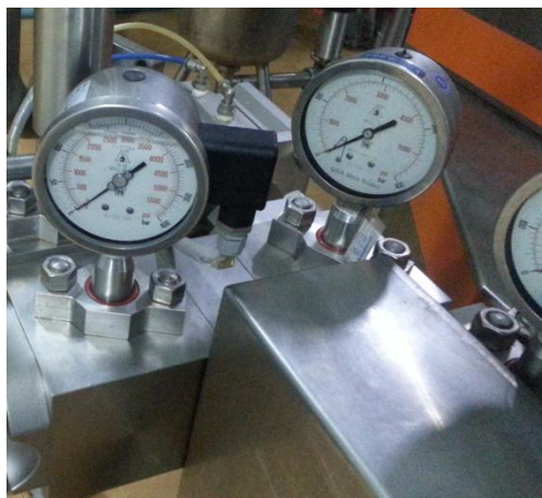
ภาพที่ 3.23 ส่วนประกอบย่อยของชุด Outlet Flange Group
