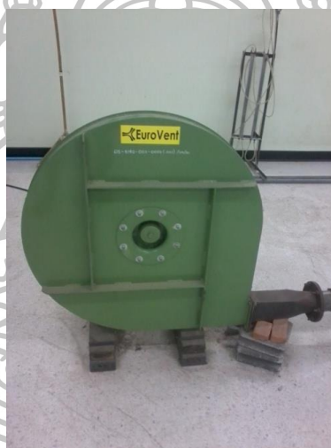
รูปที่ 3.4 พัดลมทุติยภูมิ (Blower)
