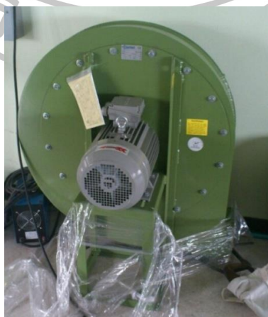
รูปที่ 3.3 พัดลมอากาศปฐมภูมิ (Blower)
